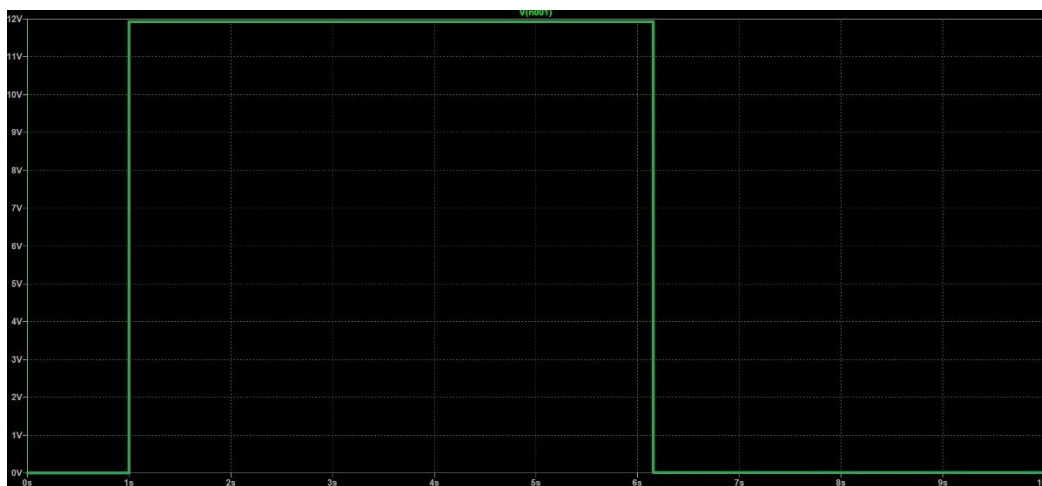
Obr. 5.7 Transientní analýza výstupu z časovače 555
