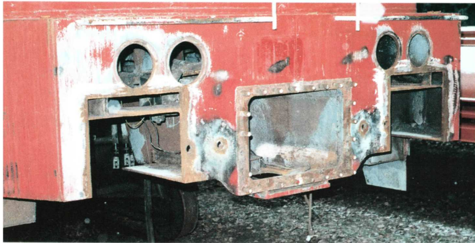
Obr. 20 Vyříznuté otvory v čelníku rámu lokomotivy řady 753, určené pro dosazení komor deformačních prvků [10]
