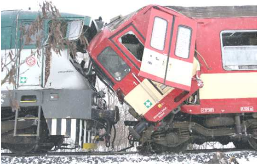
Obr. 29 Srážka motorové lokomotivy řady 754 s motorovým vozem řady 842 [1]
