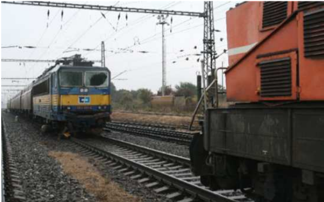
Obr. 31 Srážkou poškozená elektrická lokomotiva řady 363 [1]
