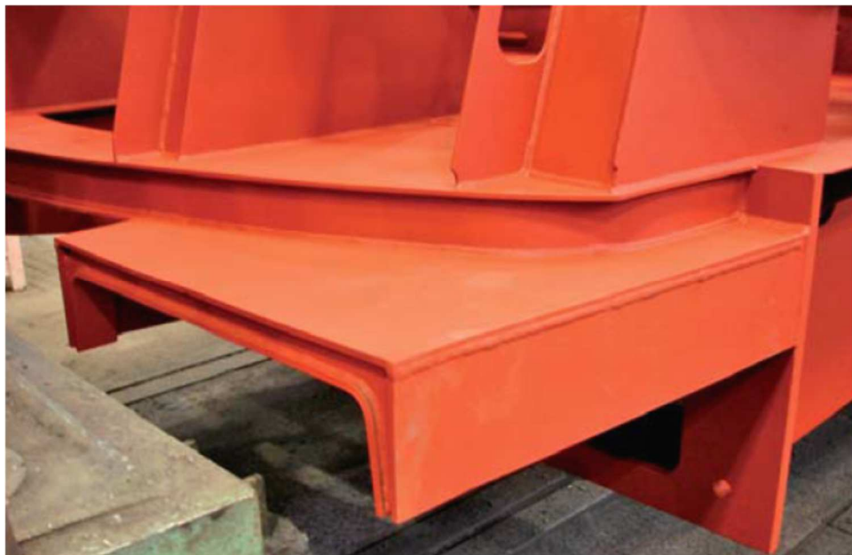
Obr. 16 Provedení „protišplhu“ na elektrické lokomotivě ŠKODA 109E [9]
