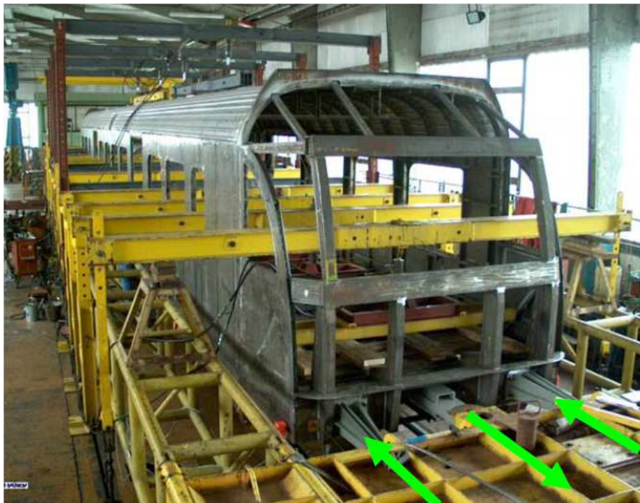
Obr. 13 Statická pevnostní zkouška hrubé skříně – zatěžování podélnými a svislými silami [7]
