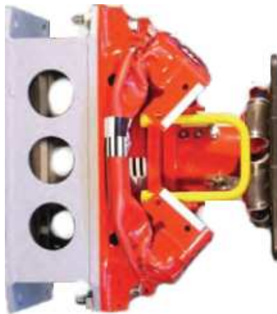
Obr. 24 Aktivovaný Crash nárazník EST G1 v kombinaci s pohlcovacím blokem EST A1 [11]
