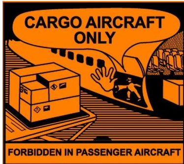
Obrázek 12 Štítek zakazující naložení na letadlo přepravující cestující (Labelmaster, 2018a)
