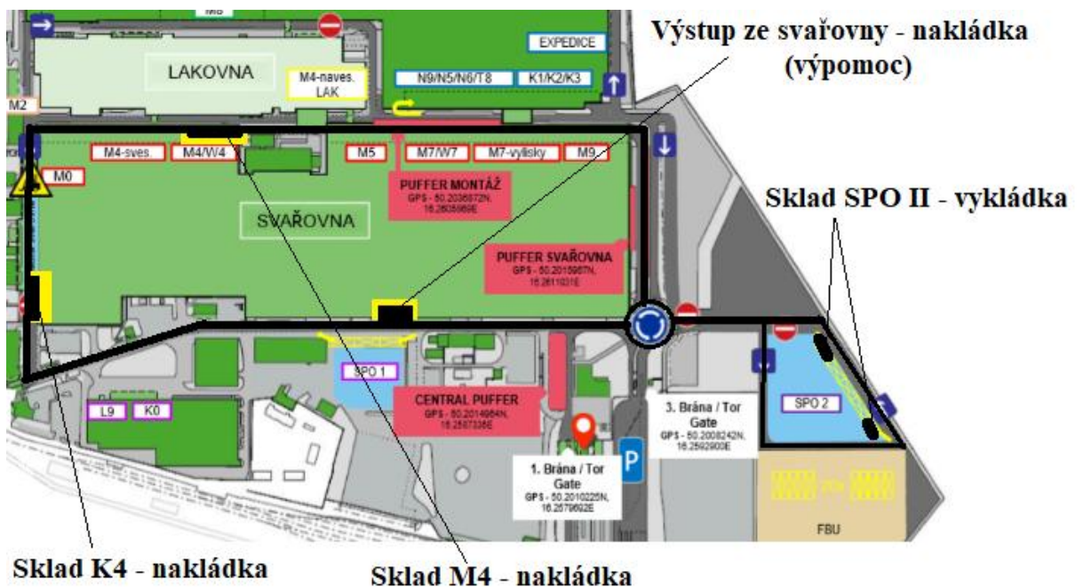
Obrázek 24 Sběr prázdných přepravních prostředků 4. LKW ze skladů M4, K4 + z výstupu ze svařovny na SPO II (ŠKODA AUTO, 2018; autor)
