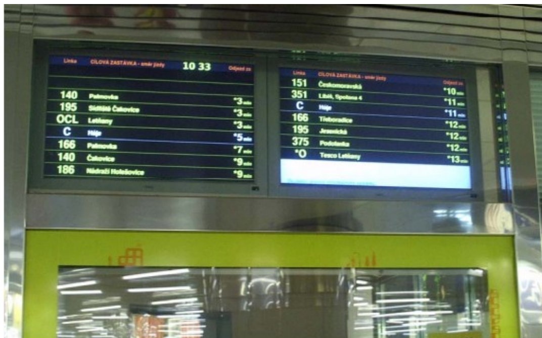
Obrázek 15 Vzhled a vhodné umístění zobrazovacího panelu LCD (Apex, 2018b)
