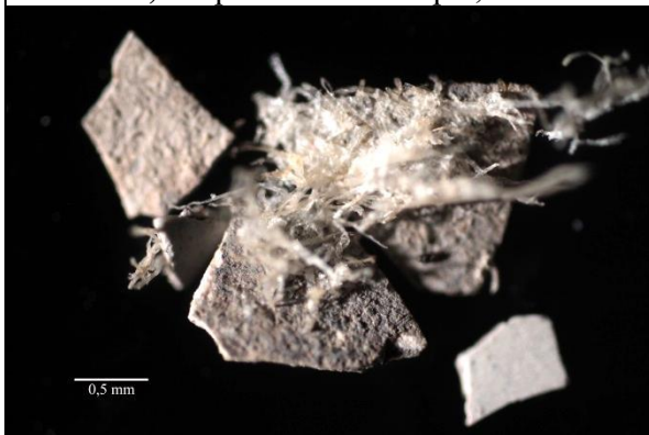
Obr. 6, 7 Optická mikroskopie, vzorek ze svrchní strany, bílé světlo a UV fluorescence.
