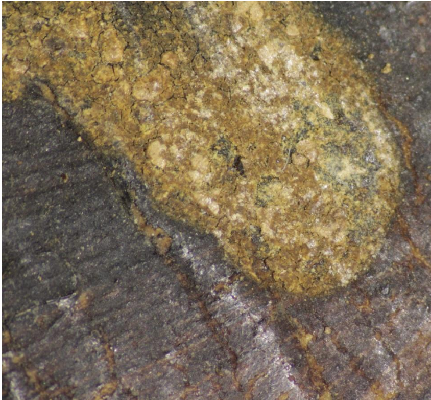
Obr. 9. Detail – struktura hnědožluté skvrny, lícová strana, stav před restaurováním, pod mikroskopem.
