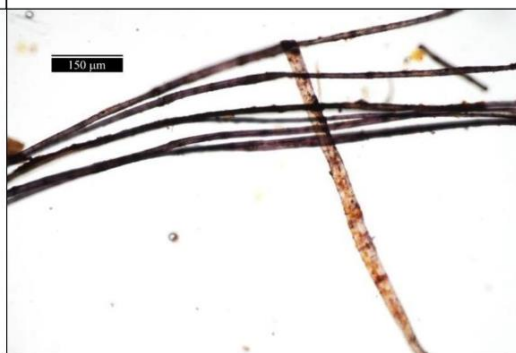
Obr. 9, 10 Optická mikroskopie, Herzbergovo činidlo, procházející světlo, zvětšení 200 ×.
