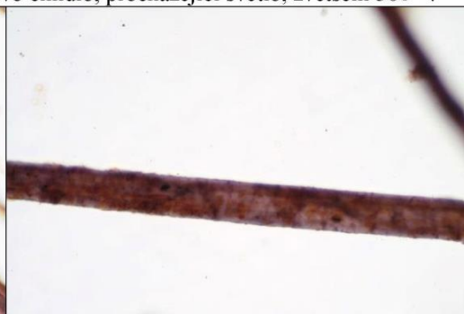
Obr. 13, 14 Optická mikroskopie, Herzbergovo činidlo, procházející světlo, zvětšení 500 ×.
