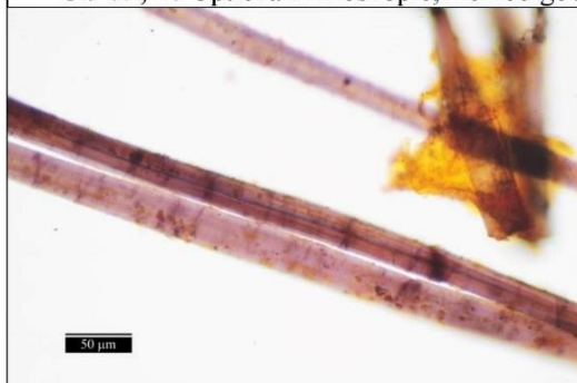
Obr. 11, 12 Optická mikroskopie, Herzbergovo činidlo, procházející světlo, zvětšení 500 ×.
