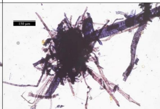
Obr. 2, 3 Optická mikroskopie, Herzbergovo činidlo, procházející světlo, zvětšení 200 ×.
