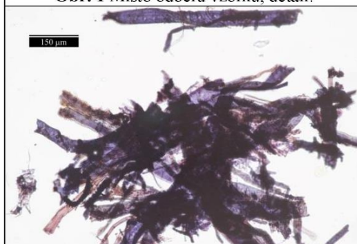
Obr. 2, 3 Optická mikroskopie, Herzbergovo činidlo, procházející světlo, zvětšení 200 ×.
