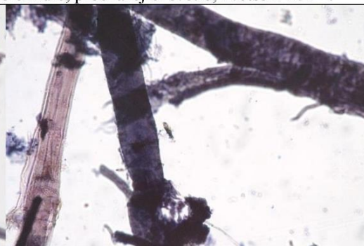
Obr. 4, 5 Optická mikroskopie, Herzbergovo činidlo, procházející světlo, zvětšení 500 ×.
