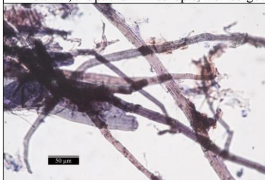
Obr. 4, 5 Optická mikroskopie, Herzbergovo činidlo, procházející světlo, zvětšení 500 ×.
