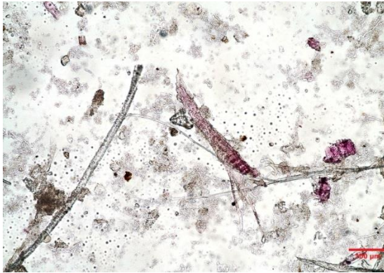
Obrázek 13 Vlákňinové složení ve vzorku papírnaše VK_07, roztok floroglucinolu
