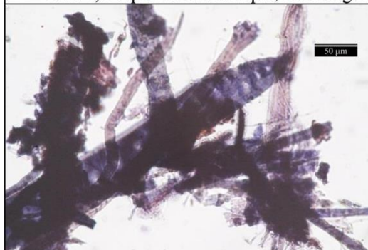
Obr. 6, 7 Optická mikroskopie, Herzbergovo činidlo, procházející světlo, zvětšení 500 ×.
