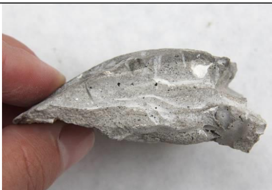
Obr. 8 - světle šedý jemnozrnný tmel
