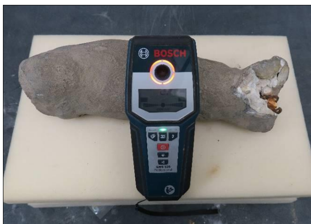
Obr. 21 – měření multidetektořem GMS 120 Professional
