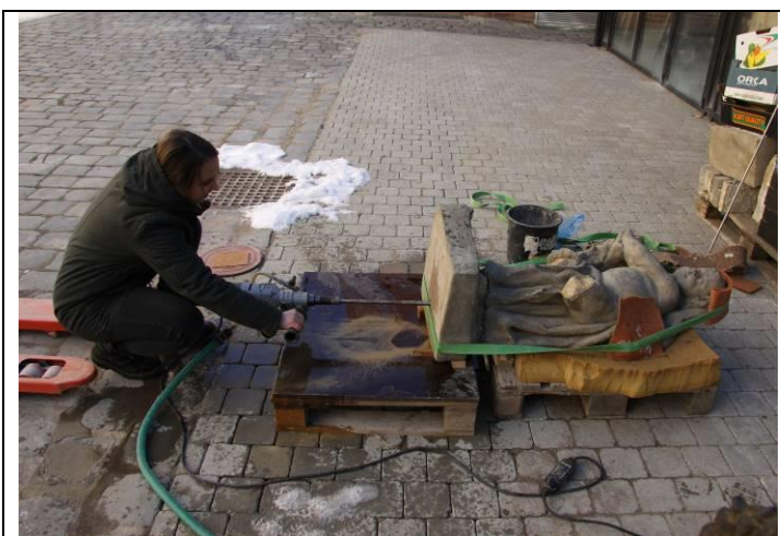
Obr. 38 - vrtání jádrovou vrtačkou
