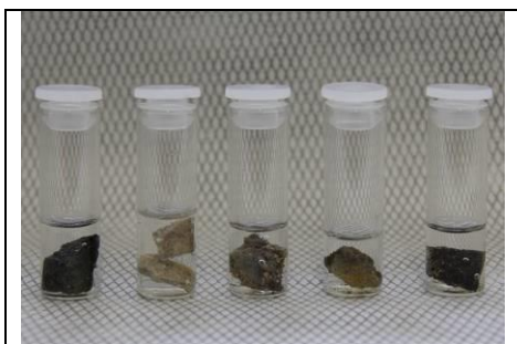
Obr. 37 – způsob zkoušky ponořením
