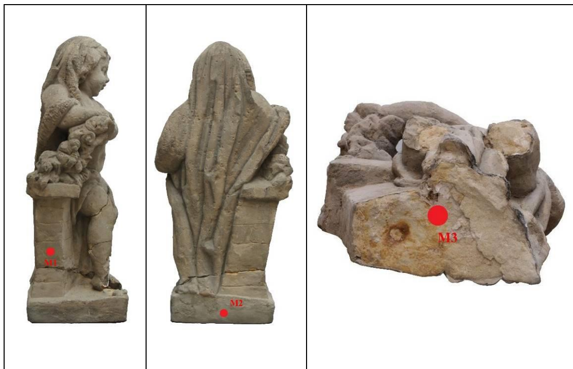
Obr. 24 a), b), c) – místa měření nasákavosti (M1 – zcelující povrchová úprava, M2 – tmel, M3 – lomová plocha kamene)
