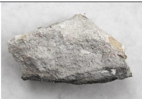
Obr. 6 - bílý tmel s plnivem
