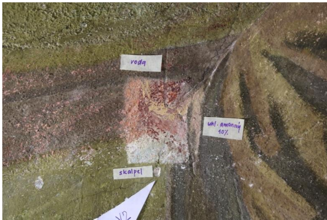
Obr. 35 Zkoušky odstranění přemalby z 19. stol. – skalpelem, vodou a 10% (hm.) roztokem uhličitanu amonného. Zkouška v oblasti předělu mezi figurami C a D, restaurovaný úsek.
