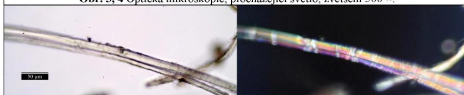
Obr. 5, 6 Optická mikroskopie, procházející světlo, normální a polarizované X, zvětšení 500 ×.
