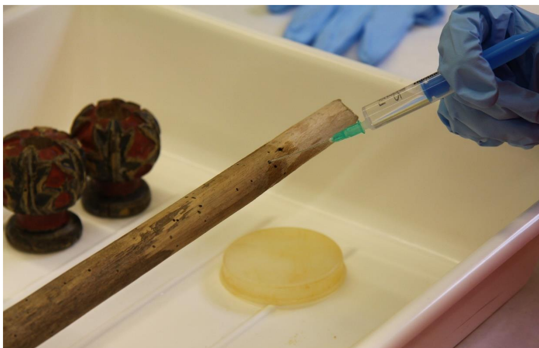
Obrázok 79 Injektáž drevenej žrde riedeným roztokom Bochemitu, dezinfekčný zásah
