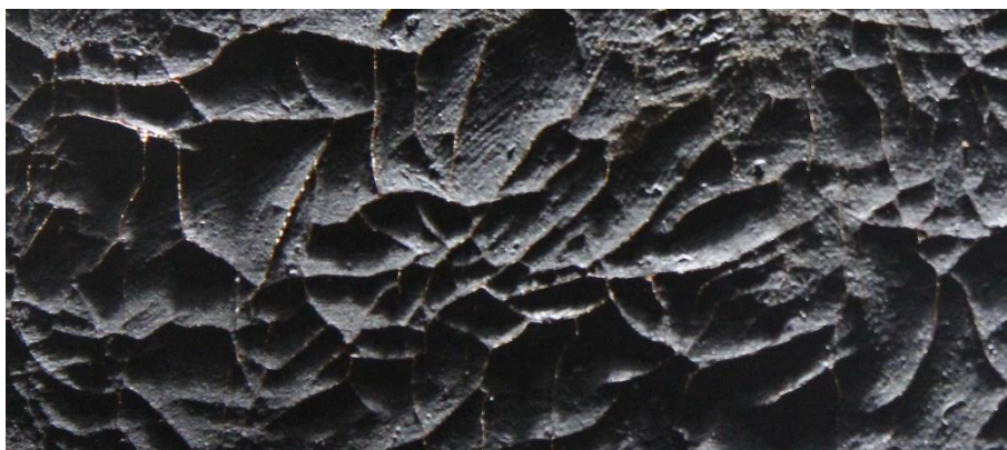
Obrázok 122 Miskovitá krakeláž v razantnom bočnom osvetlení
