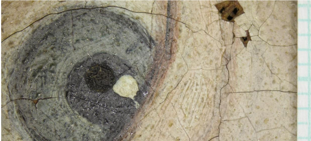
Obrázok 119 Primárne (menej roztvorené) i sekundárne (viac roztvorené) krakely, macro snímka
