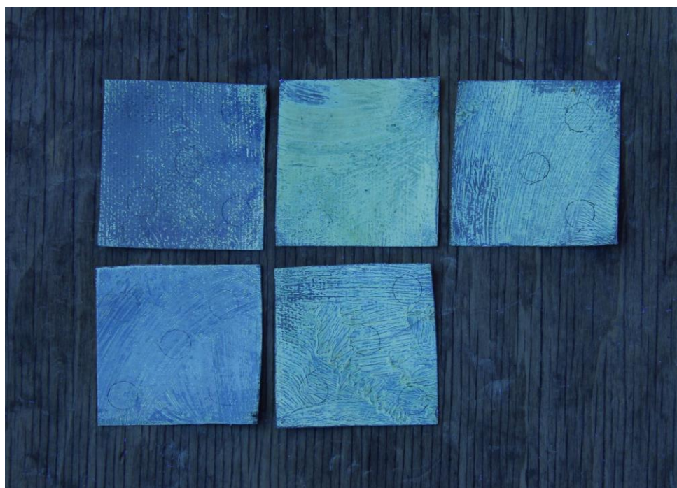
Obrázok 21 Farebné vzorky po starnutí 30 dní pod UV žiarením.
