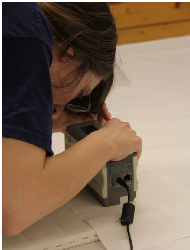
Obrázok 15 Meranie vzoriek Spektrofotometrom.
