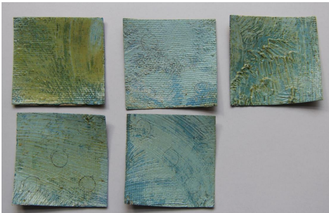
Obrázok 20 Farebné vzorky po starnutí 30 dní a skúškach rozpustnosti lakovej vrstvy.
