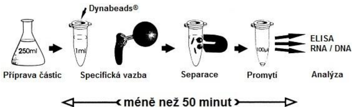
Obrázek 12: Princip imunomagnetické separace mikroorganismů. Převzato a upraveno z Horton et al., 1989
