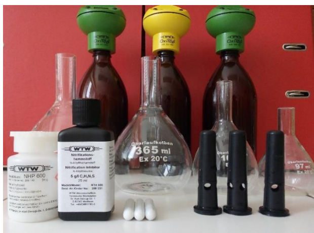
Obrázek 7: Zařízení pro měření BSK 5 respirometrickou metodou
