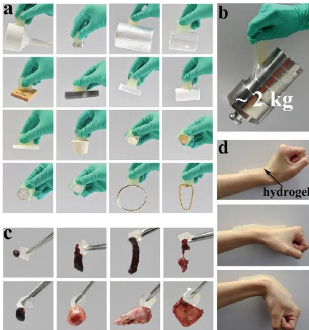
Obrázek 10 - Kasein-PPAm hydrogel a jeho přilnavost k různým substrátům [30].
