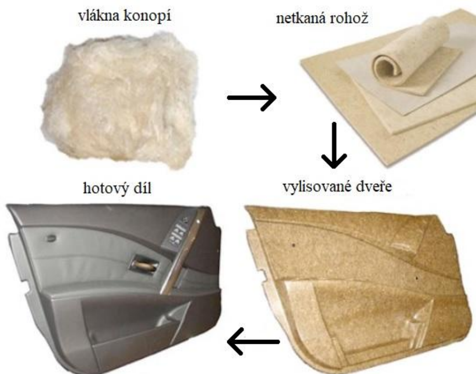
Obrázek 13 - Kompozitní díl vyztužený konopnými vlákny [37].
