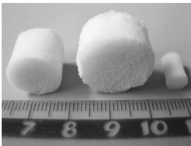
Obrázek 19 - Porézní houba tvořená z kolagenu a hydroxyapatitu [50].
