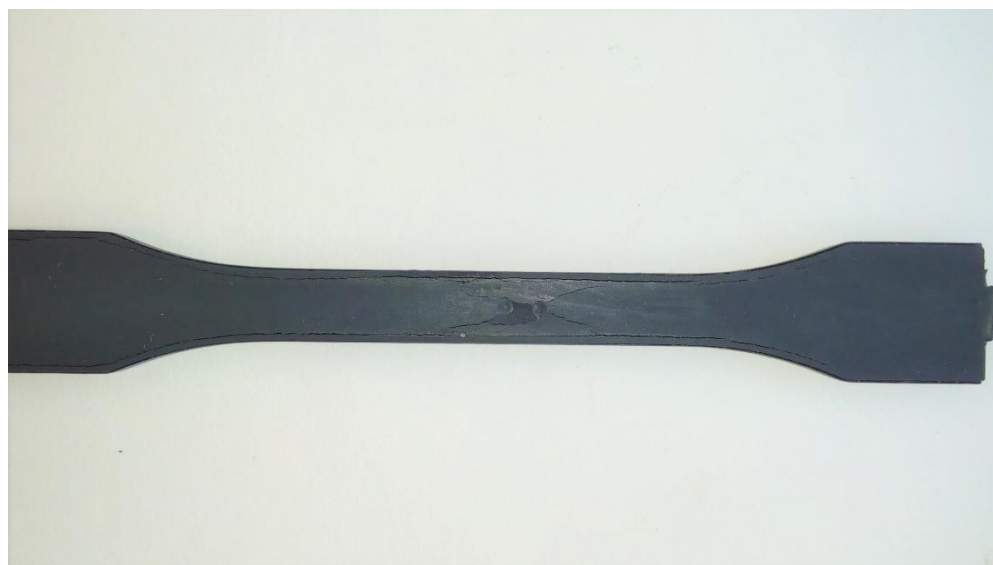
Obrázek 12 - Zkouška tvrdosti PC po měsíci v kyselině sírové
