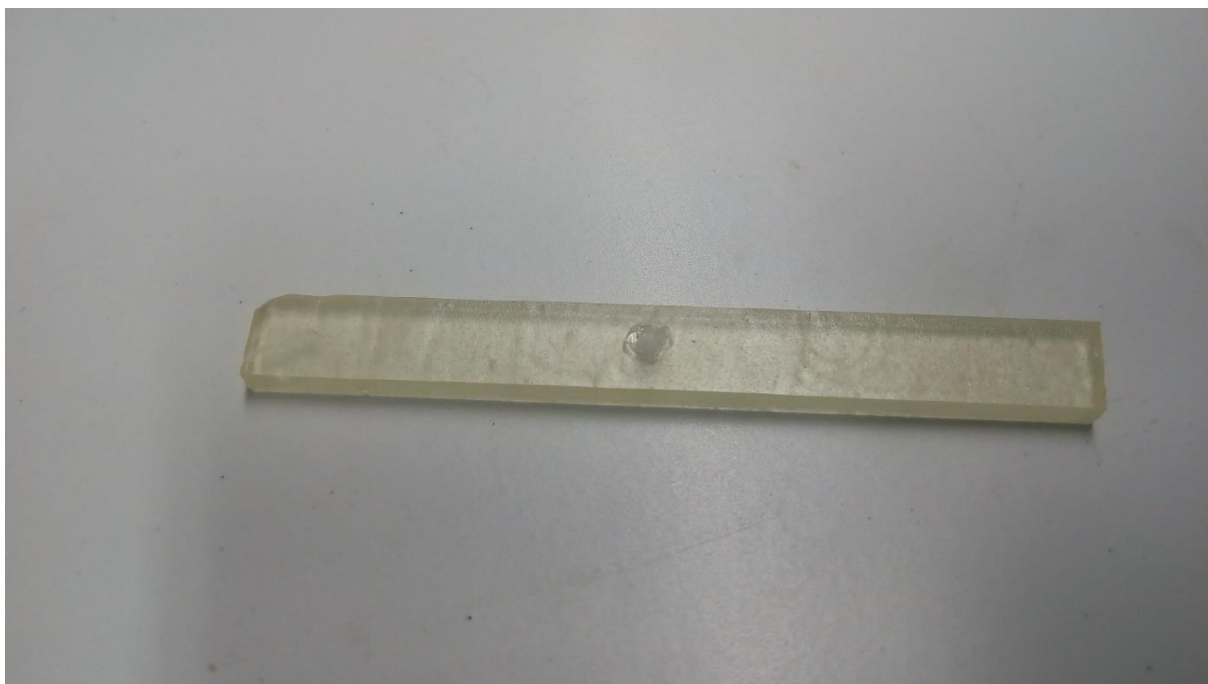
Obrázek 15 - Tělísko z CHS EPOXY 520 + DMB v benzínu po 7 dnech
