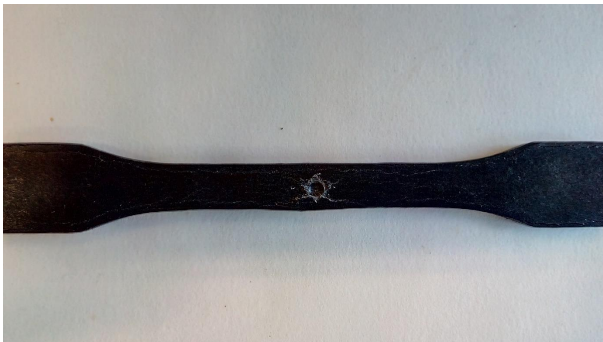
Obrázek 10 - Detail poškození PA při zkoušce tvrdosti
