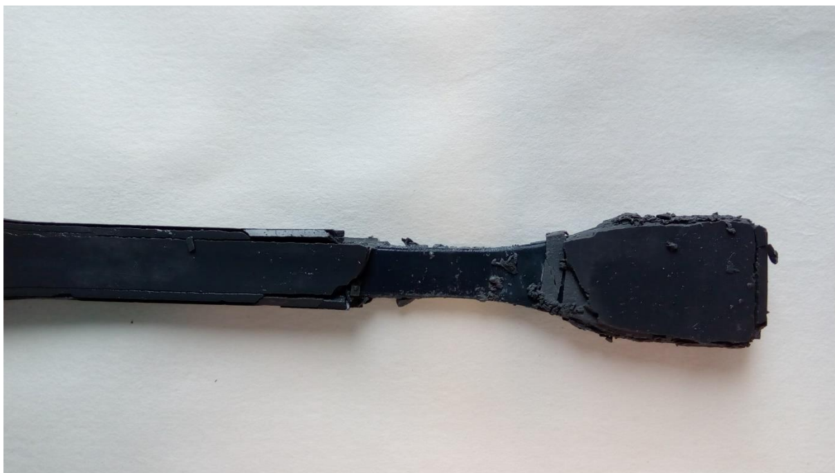
Obrázek 13 - Vliv hydroxidu sodného na PC po 180 dnech
