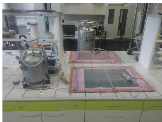
Obrázek 45: Vakuová infuze na 2 formách
