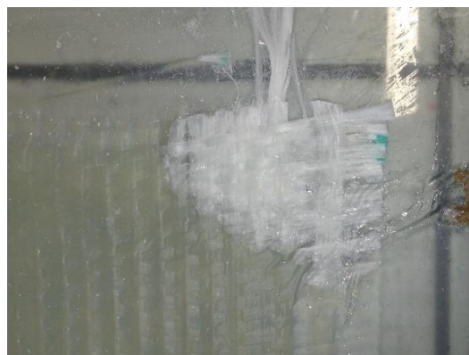
Obrázek 48: Křehký systém CHS epoxy 520 a Telalit 420
