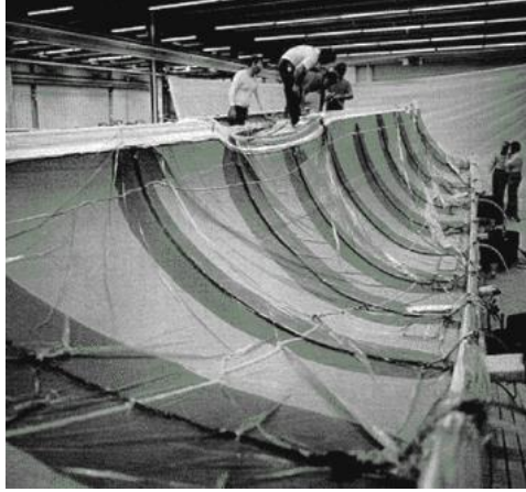
Obrázek 22: Část lodi vyráběná metodou SCRIMP [37]
