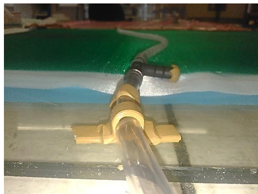
Obrázek 39: Skládání formy – příprava vtoku (2.část)
