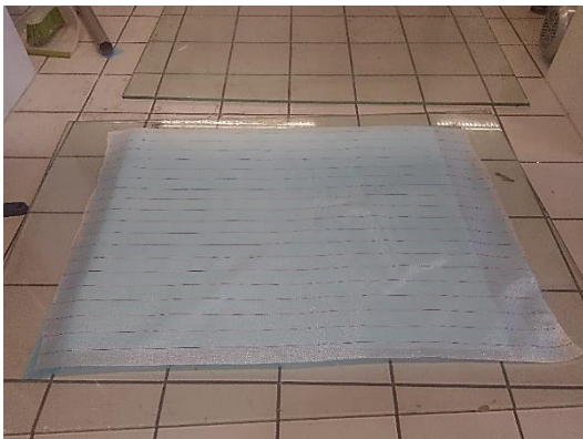
Obrázek 36: Skládání formy – odtrhová tkanina
