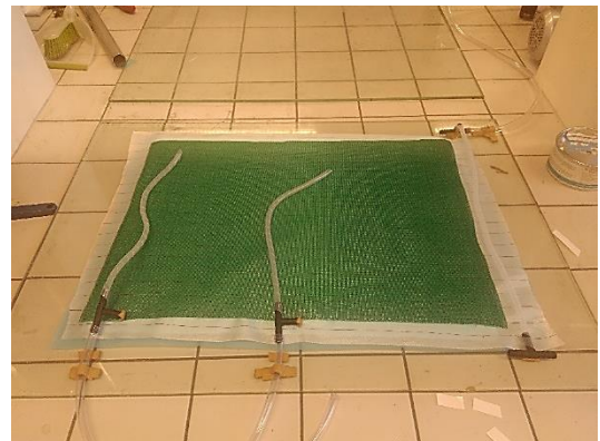
Obrázek 37: Skládání formy – rozvodová tkanina se vtoky a vstupem vakua
