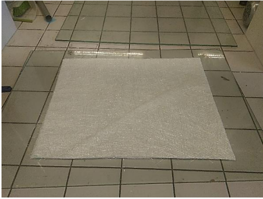
Obrázek 34: Založení tkaniny do formy
