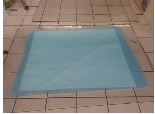
Obrázek 35: Skládání formy – separační folie
