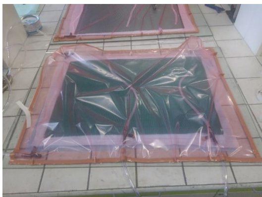
Obrázek 42: Skládání formy – lepení vakuovací folie
