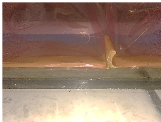
Obrázek 41: Skládání formy – tvoření „výstupků“
