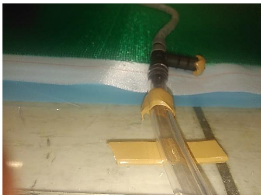
Obrázek 38: Skládání formy – příprava vtoku(1.část)
