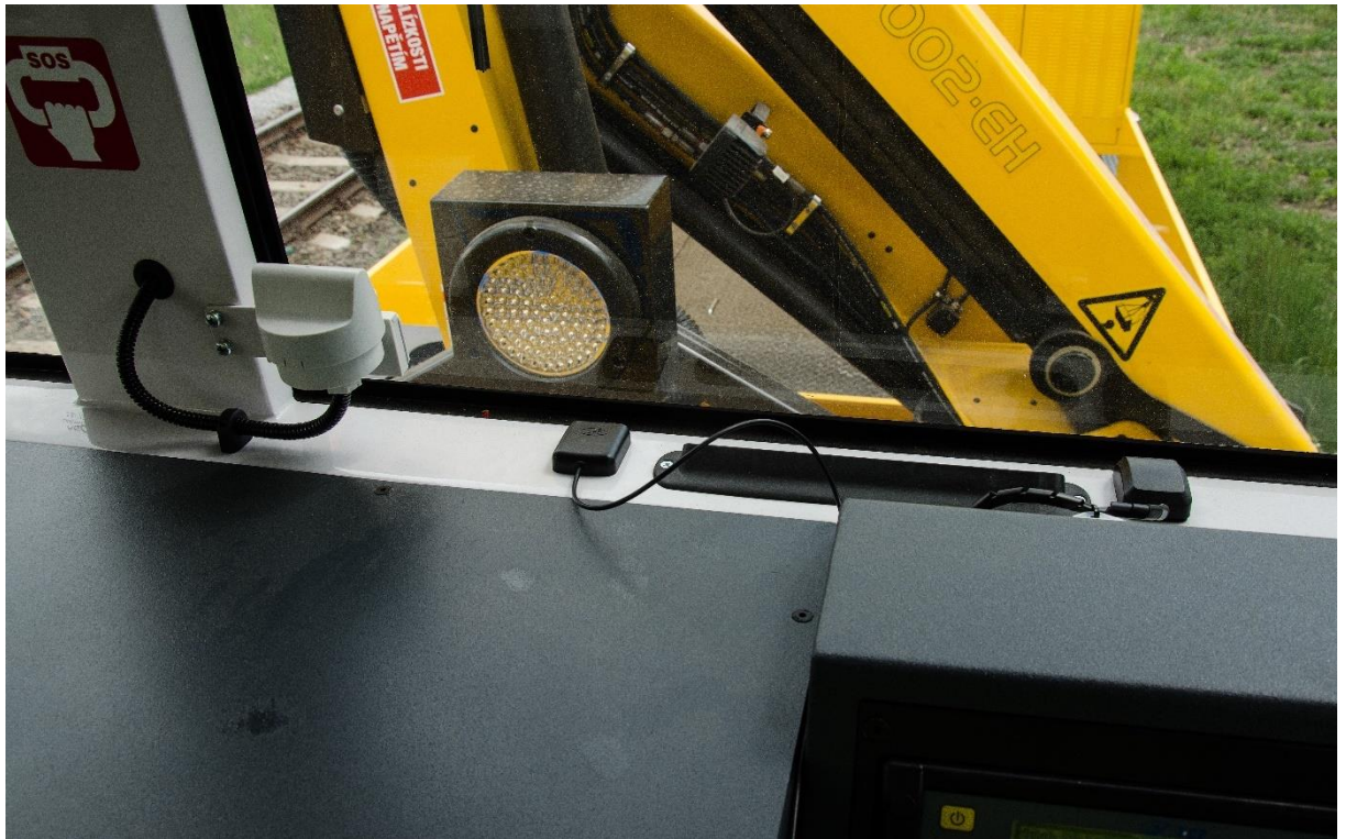
Obrázek 40 Prostřední z antén je anténa pro GPS vytvořeného systému vzdálené diagnostiky
