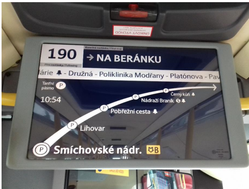
Obrázek 15 Vnitřní elektronický panel s časem a pásmem (autor)
