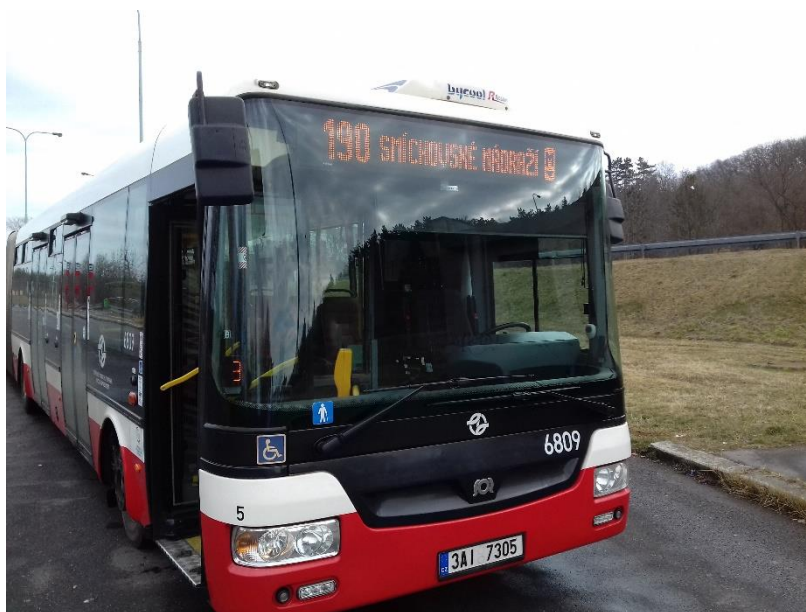
Obrázek 13 Vnější elektronický panel s piktogramy na přední straně vozidla (autor)
