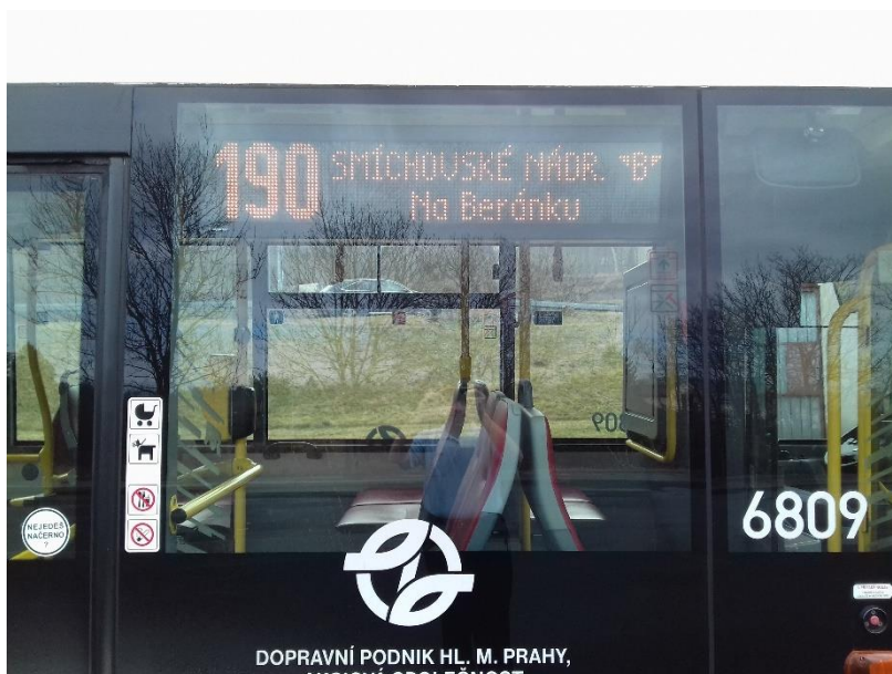
Obrázek 14 Vnější elektronický panel na pravé straně vozidla s informačními samolepkami (autor)
