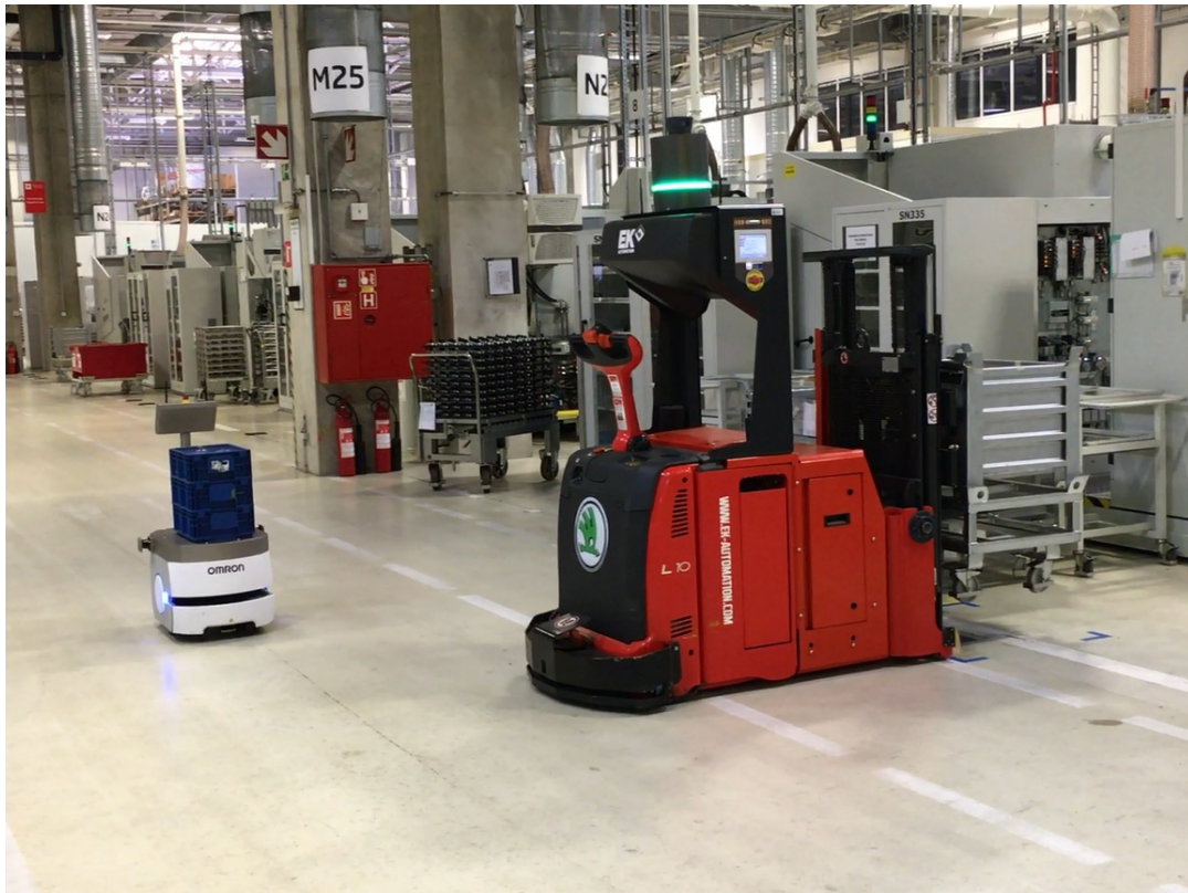
Obrázek 24 Testování mobilního robota, vyhnutí se překážce (Autor, 2017)
