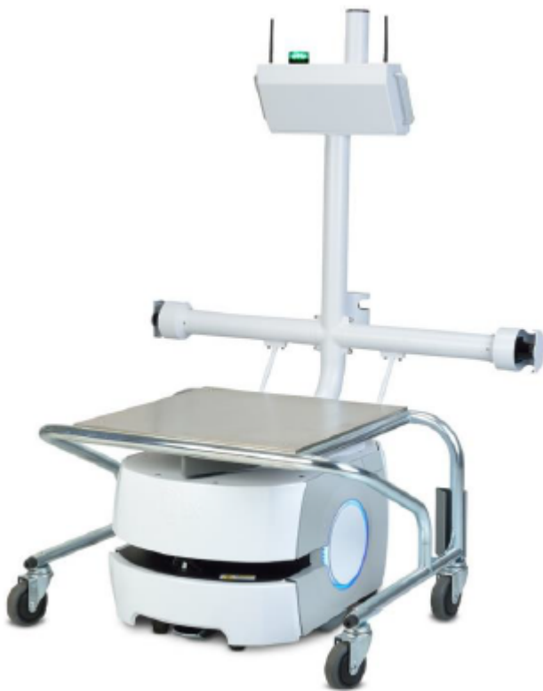
Obrázek 18 Vozík pro přepravu spojený s mobilním robotem (ŠKODA AUTO a.s., 2017)
