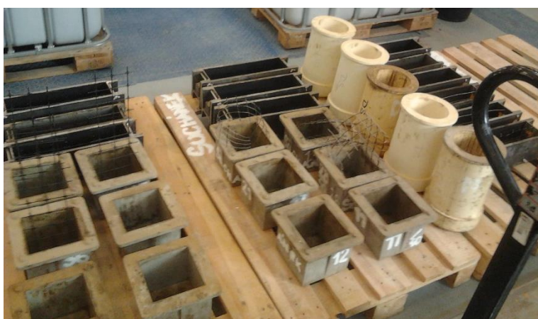
Obrázek 24. – Připravené klasické formy (před naplněním) a úprava zkušebních těles řezem (tělesa byla rozlomena při modifikované zkoušce pevnosti v tahu ohybem)
