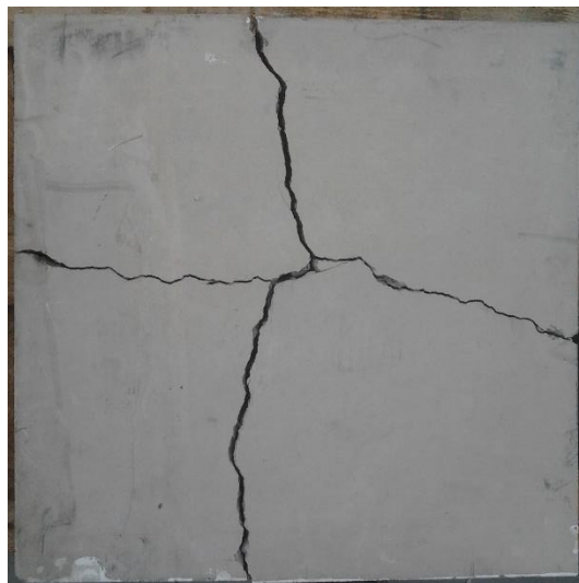
Obrázek 51. – Výztužná síť, porušené zkušební těleso 1.2.2.
