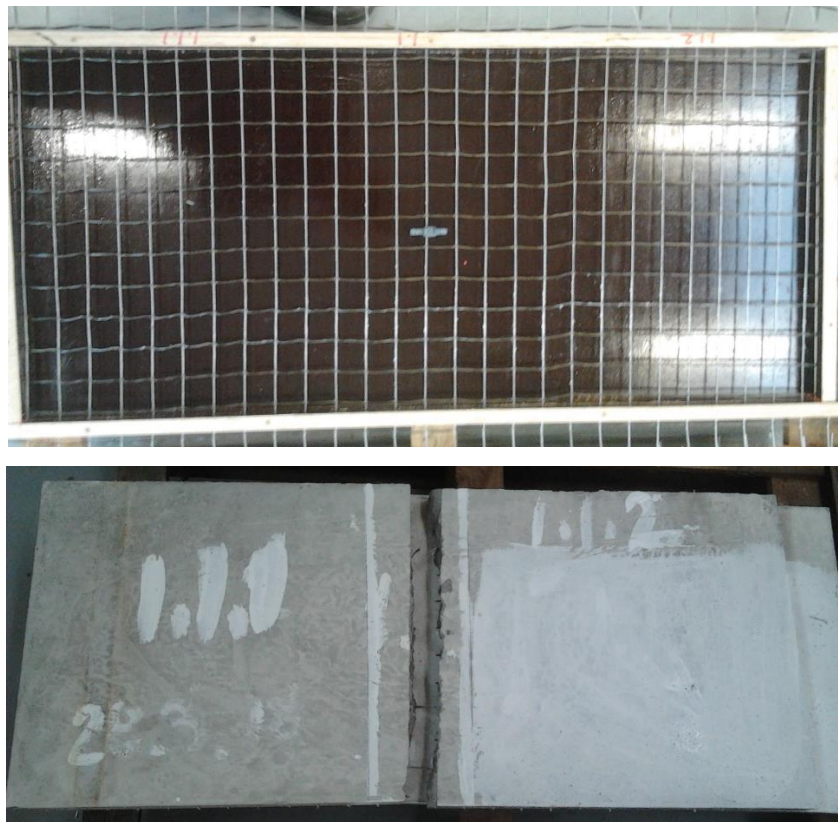
Obrázek 43. a) – Výztužná síť, porušené zkušební těleso 1.1.
