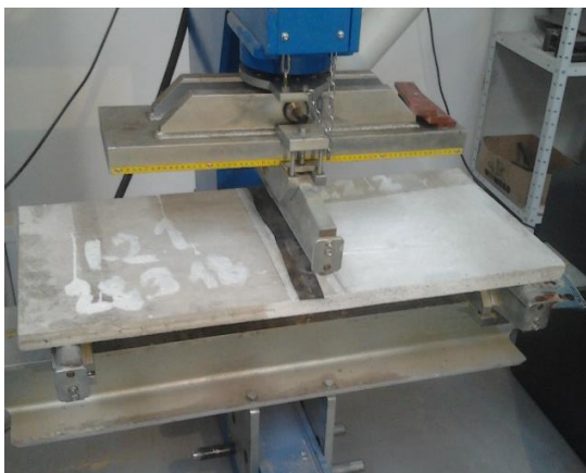
Obrázek 27. – Zkoušení desek pevnost v tahu ohybem na levé straně, zkoušení desek na průraz na pravé straně
