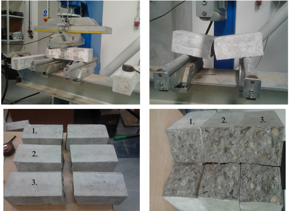
Obrázek 32. – Zkouška pevnosti v tahu ohybem (nahore), porušena zkušební tělesa (dole)
