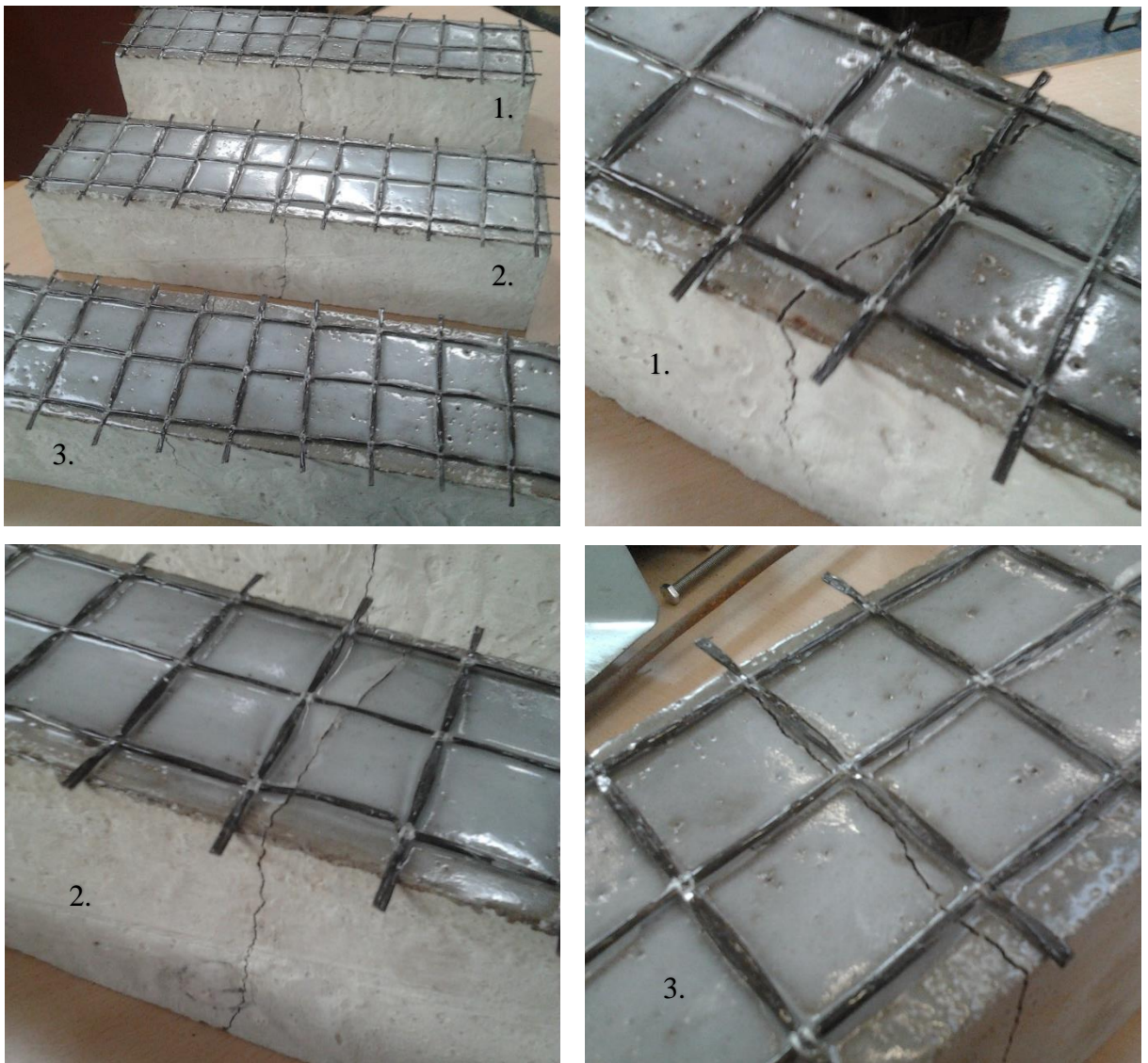
Obrázek 41. – Porušená zkušební tělesa Alligard a epoxidová pryskyřice
