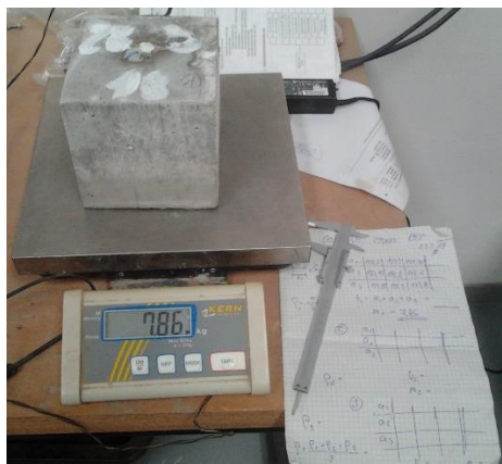
Obrázek 30. – Zkouška objemové hmotnosti ztvrdlého betonu
