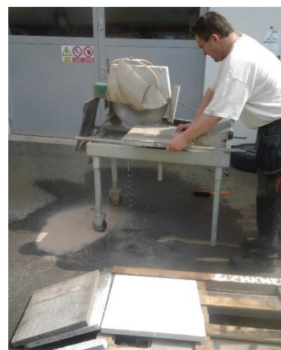
Obrázek 24. – Připravené klasické formy (před naplněním) a úprava zkušebních těles řezem (tělesa byla rozlomena při modifikované zkoušce pevnosti v tahu ohybem)
