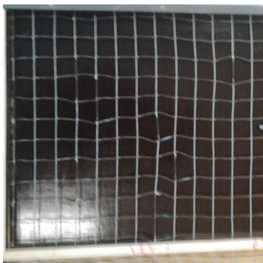
Obrázek 52. – Výztužná síť, porušené zkušební těleso 1.3.2.
