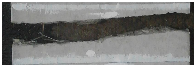
Obrázek 44. – Výztužná síť, porušené zkušební těleso a detail porušení tělesa 1.2.
