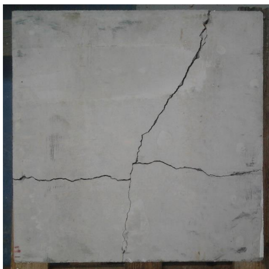
Obrázek 38. – Porušené zkušební těleso 3.2.1.
