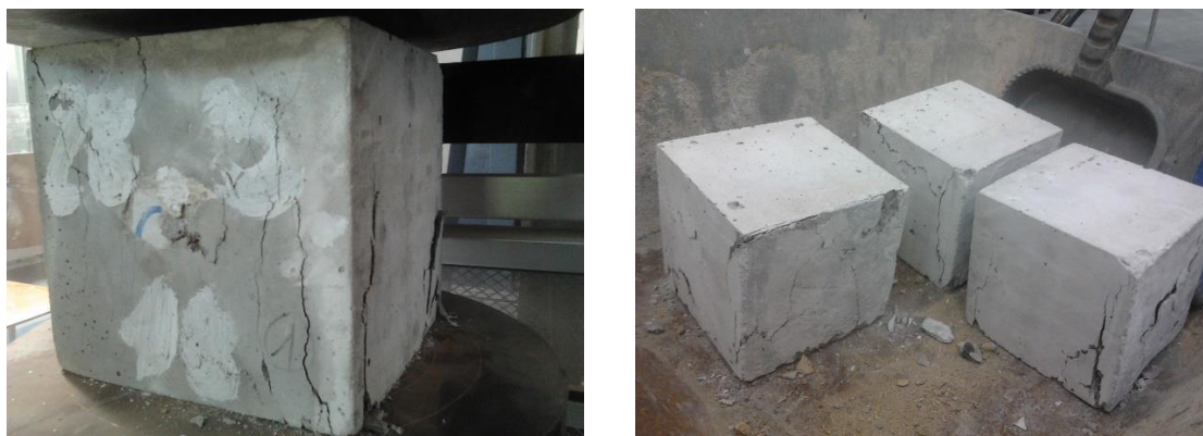
Obrázek 31. – Zkouška pevnosti v tlaku (na levé straně), porušené krychle (na pravé straně)
