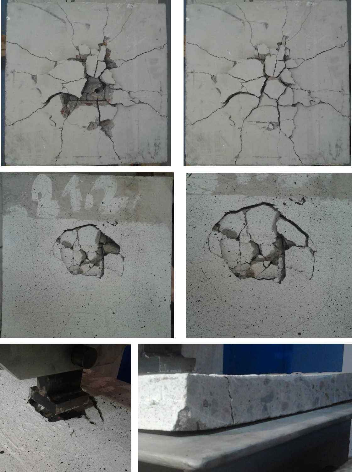
Obrázek 54. – Porušené zkušební těleso 2.1.2. spodní povrch (nahore), horní povrch (uprostřed), proražení lisem a přízdvihování rohů (dole)
