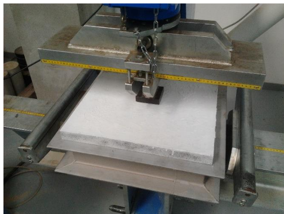
Obrázek 27. – Zkoušení desek pevnost v tahu ohybem na levé straně, zkoušení desek na průraz na pravé straně
