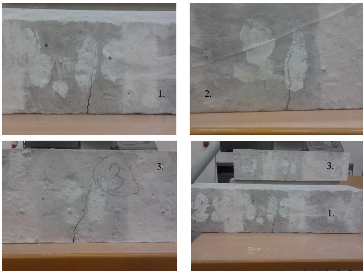
Obrázek 42. – Porušená zkušební tělesa ROCKMESH
