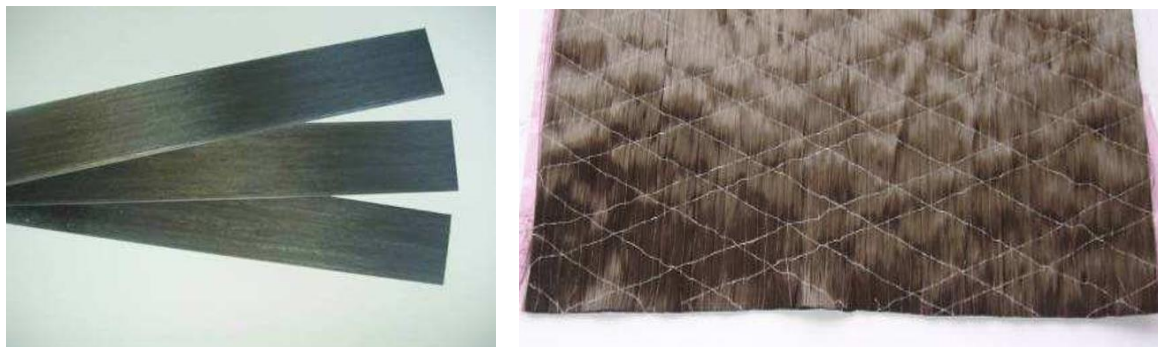
Obrázek 9. – Lamely pro vnější dodatečné zesilování (na levé straně) a Tkanina z uhlíkových vláken pro vnější dodatečné zesilování (na pravé straně) [6]
