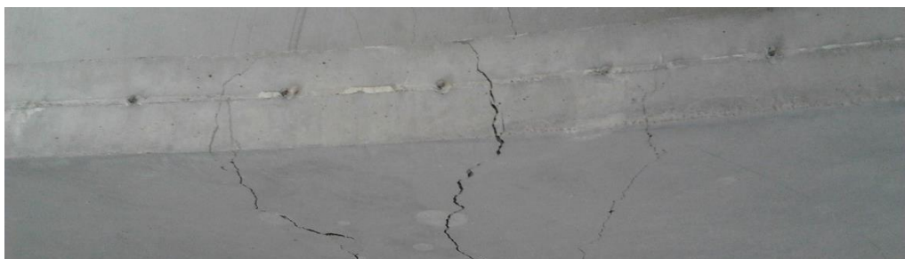
Obrázek 48. – Detail porušené zkušební těleso 2.3.
