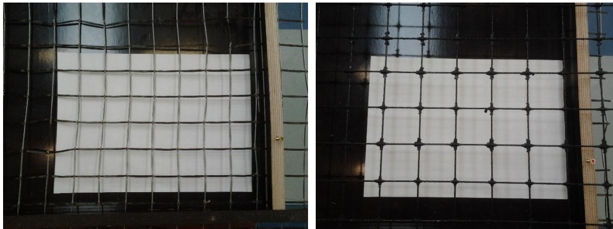
Obrázek 21. – Výztužná síť Alligard (vlevo) a výztužné mřížka ROCKMESH (na pravé straně) Poznámka: čedičová síť / mřížka podložena listem papíru A4
