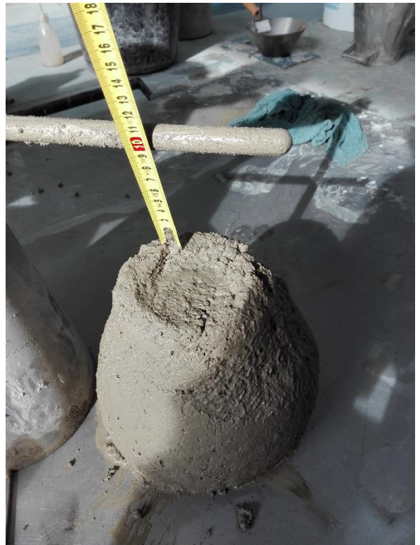
Obrázek 7 – Vyhodnocení zkoušky sednutím [vlastní foto]
