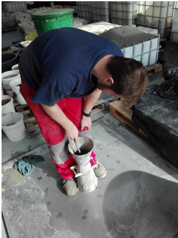
Obrázek 8 – Plnění Abramsova kužele [vlastní foto]
