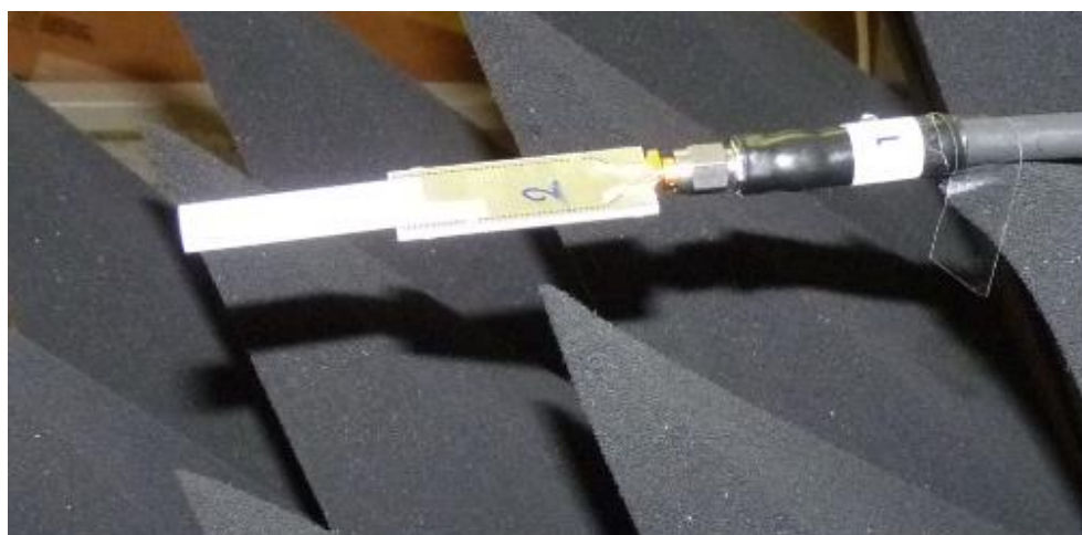
Obrázek 43 - Zobrazení měřené antény s dielektrickou tyčí
