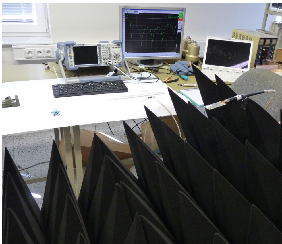
Obrázek 42 - Zobrazení měření S parametrů antén
