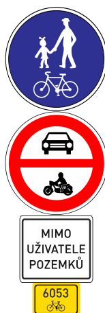
Obrázek 15: Nesprávné umístění více DZ na sloupku – C9a, B11 a IS21a na 27d, Rešov
