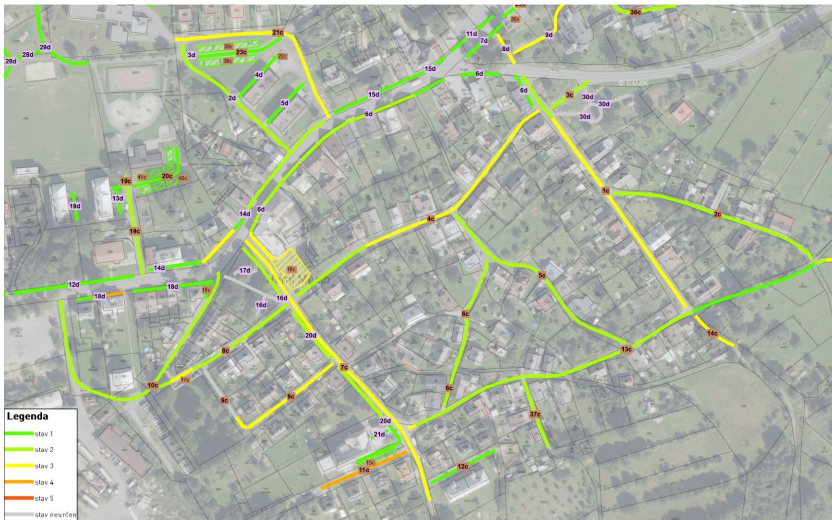
Obrázek A: Příklad analýzy dat v ArcMap – obarvení MK podle stavu povrchu
