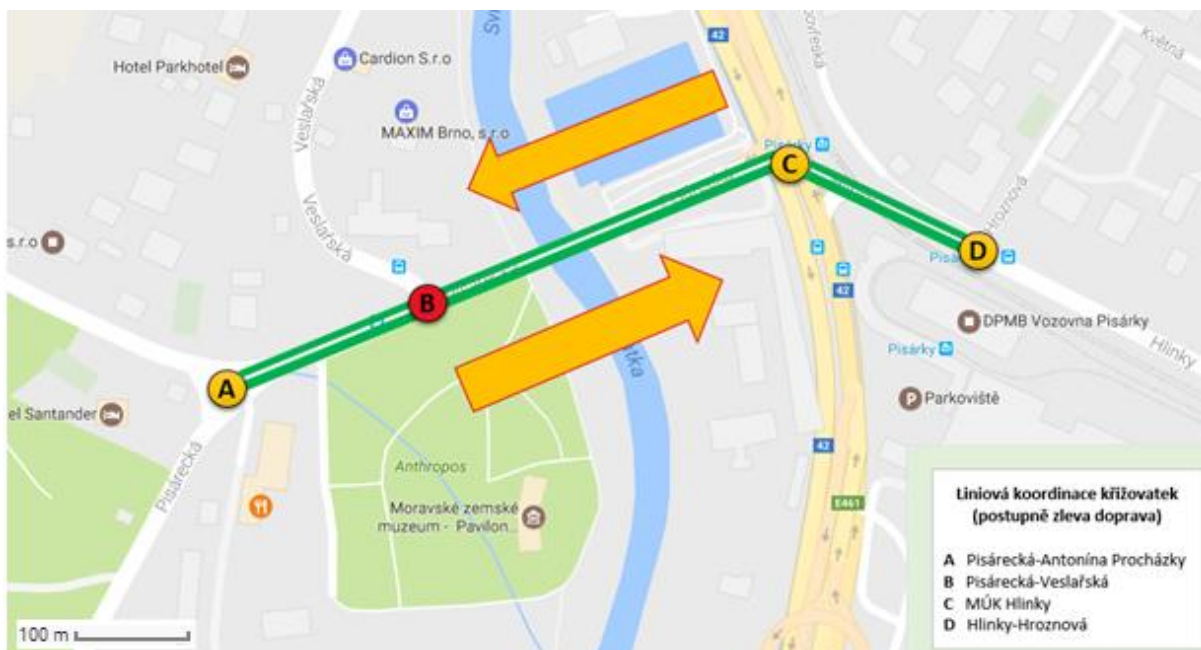
Obrázek č.13 Křižovatky zařazené do koordinace a směry hlavních zohledněných dopravních tahů
