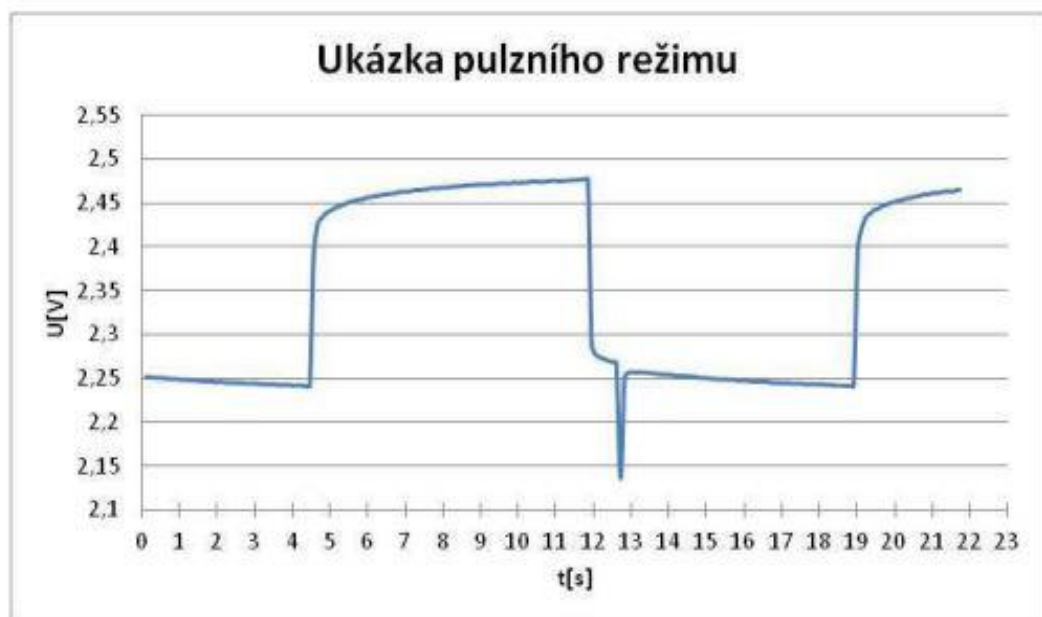
Obr. 2.5 Ukázka průběhu napětí na článku při použitím pulzním režimu [19]
