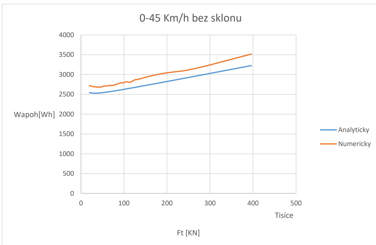
Obrázek 16 Graf zjištěných závislostí energie na rozjezd vozidla z 0 na 45 Km/h na tažné síle na přímé trati bez sklonu
