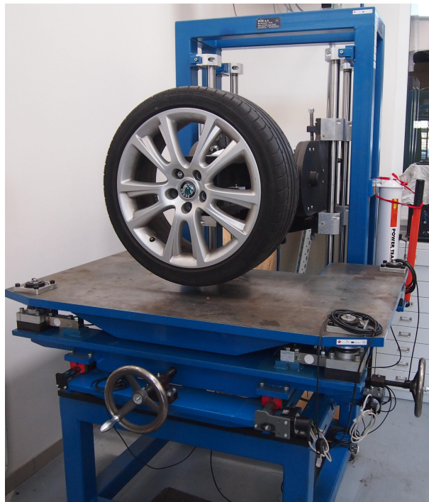
Obrázek 2.2: Statický adhezor v laboratoři VVCD
