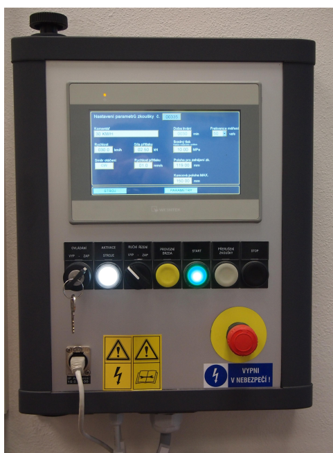
Obrázek 3.3: Ovládací panel adhezoru DA-1
