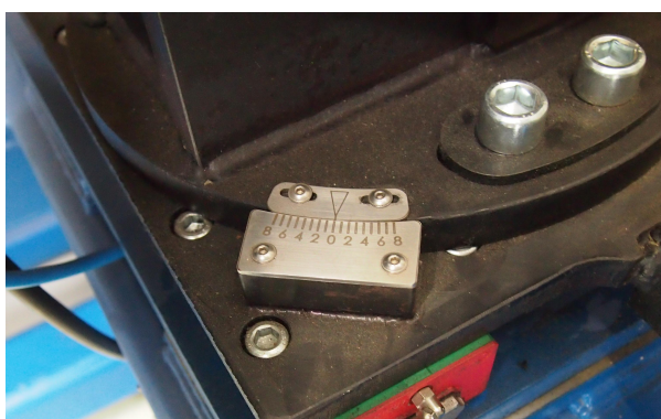
Obrázek 5.9: Detail stupnice odklonu ramene
