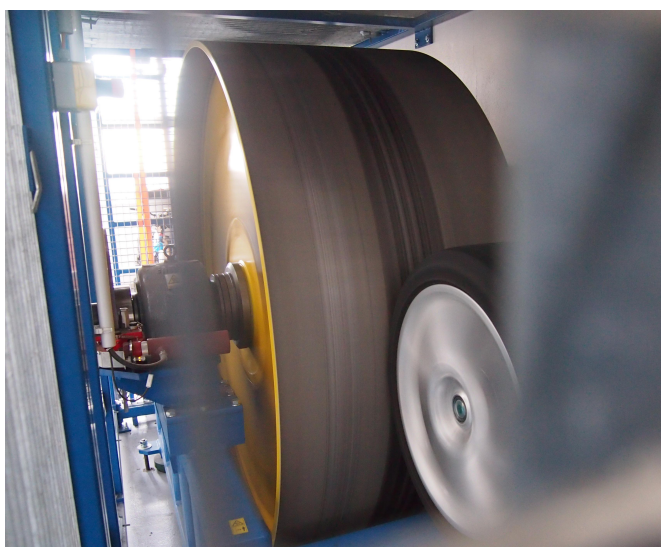
Obrázek 3.4: Dynamický adhezor DA-1 během provozu
