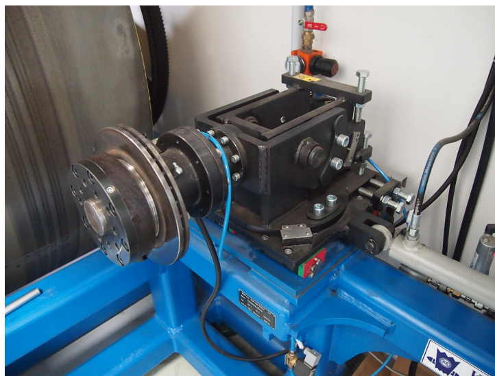
Obrázek 3.2: Posuvné rameno DA-1
