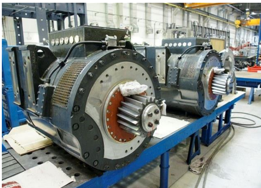
Obr. 5 Trakční motory Škoda ML 4550 K/6 s nasazeným pastorkem.
