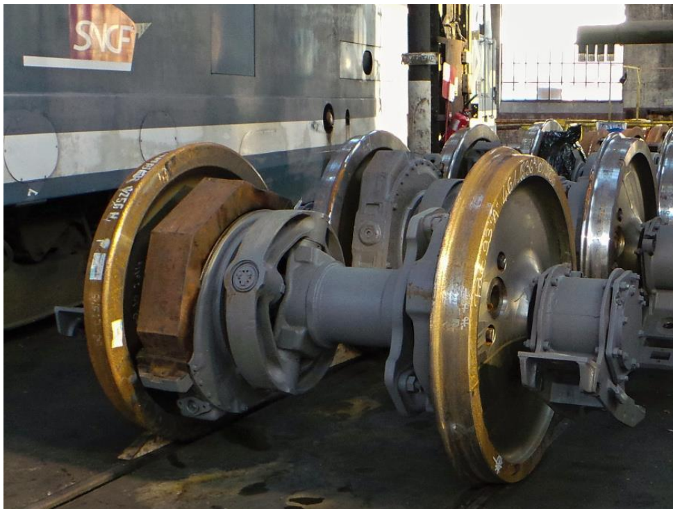
Obr. 6 Dvojkolí s dutým hřídelem a prstencovými klouby Jacquemin . Autor: Puodou . [12]
