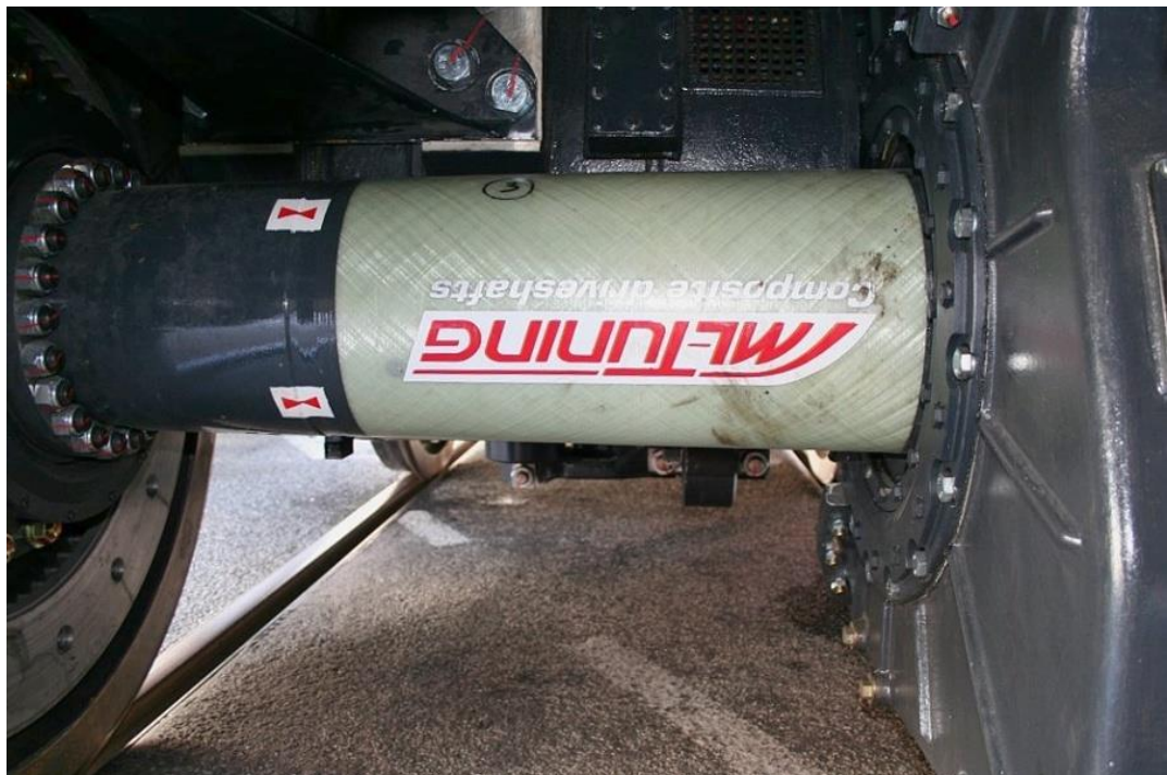
Obr. 8 Kompozitový dutý hřídel lokomotivy Škoda 109E, vlevo je patrná příruba zubové spojky a brzdový kotouč, napravo nápravová převodovka. Autor: JPB. [10]
