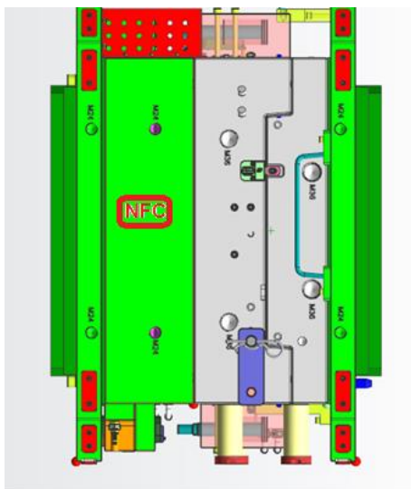
Obrázek 28 Umístění NFC tagu na formu z přední strany (Faurecia, 2018, upraveno autorem)
