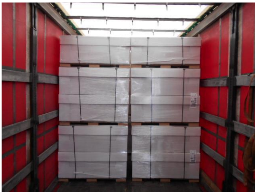
Obrázek 23 Testovací nakládká s novým balením horní výplně výrobku 8 (autor)
