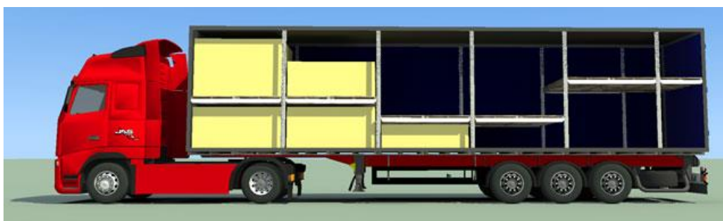
Obrázek 5 Dvoupodlažní návěs – průřez (Jastrans, 2013)
