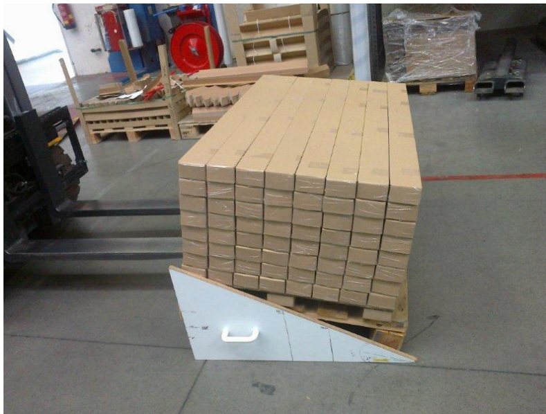
Obrázek 20 Praktické znázornění 10^\circ náklonu nefixované paletové jednotky (Vybraná společnost)
