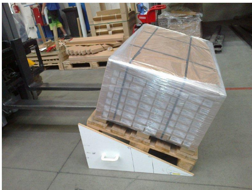
Obrázek 22 Praktické znázornění 27 ° náklonu nefixované paletové jednotky (Vybraná společnost)
