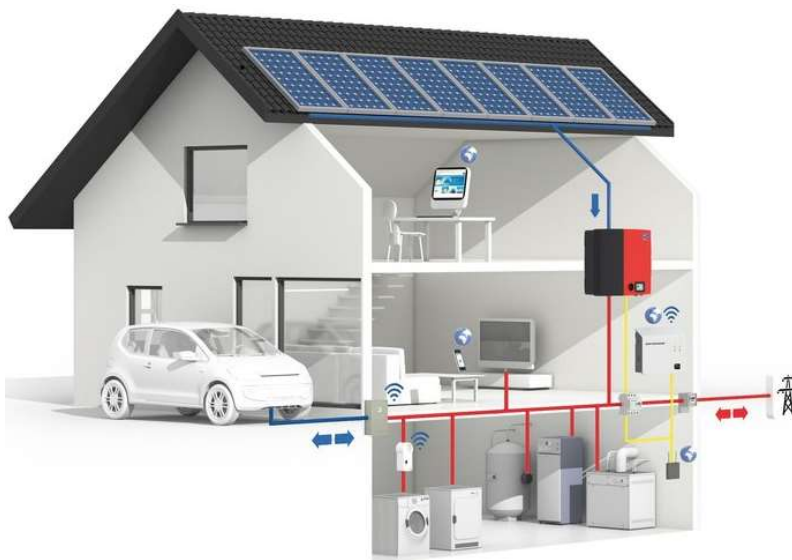
Obr. 18 Schéma zapojení fotovoltaického systému aplikovaného na rodinný dům
