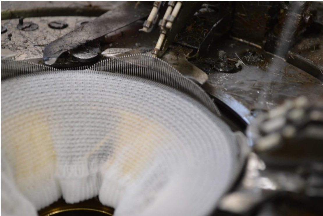
Příloha č. 5: Detailní pohled na automatický okrouhlý stroj dnešní doby pro výrobu, obsahující desítky jehel
