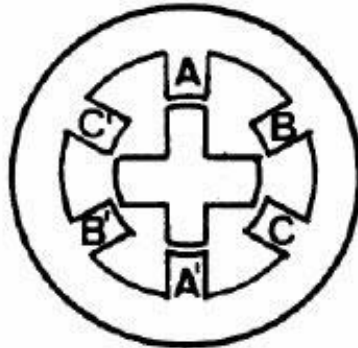
Obr. 1.14 – Princip krokového motoru s variabilní reluktancí (Pohonná technika, 2013)
