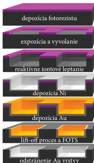
Obr. 2.24: Schéma postupu výroby formy založenej na kontraste zmáčavosti [64]
