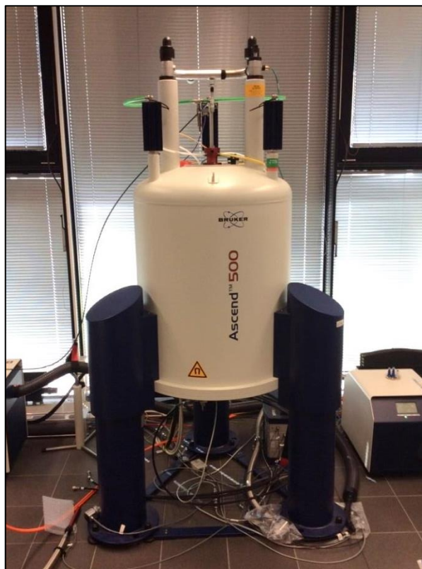
Obr. 13 - Přístroj Ascend™ 500 pro měření nukleární magnetické rezonance
