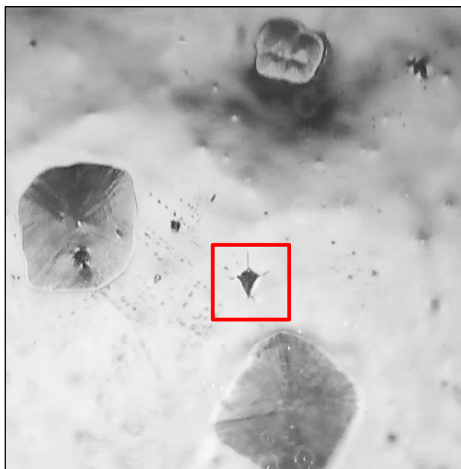
Obr. 62 - Otisk indentoru ve vrstvě s 3 mol. % TiO 2
