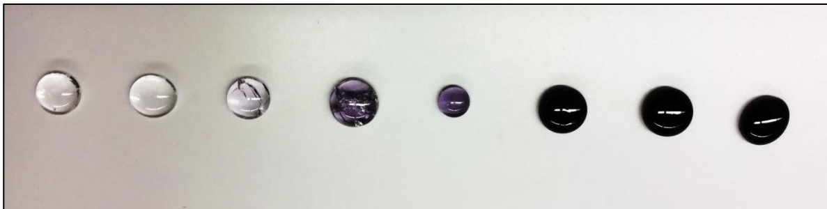
Obr. 23 - Série kvaternárních skel o složení 10\text{Na}_2\text{O}-(40-x)\text{ZnO}-x\text{TiO}_2-50\text{P}_2\text{O}_5
