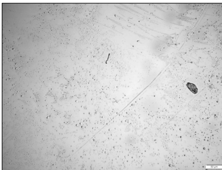
Obr. 38 - Nativní povrch skla s 0 mol. % \text{TiO}_2 před začátkem sledování rozpustnosti
