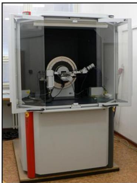
Obr. 15 - Přístroj AXS D8 pro rentgenovou difrakci
