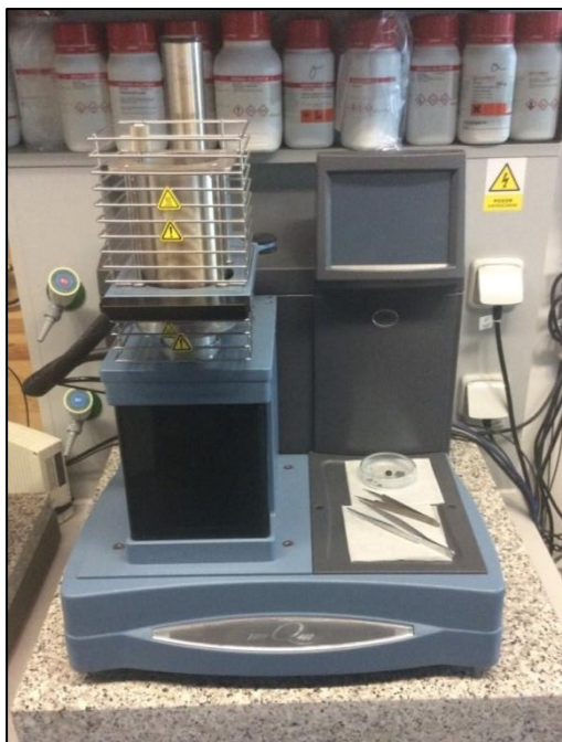
Obr. 16 - Přístroj Q400 TMA pro měření termomechanické analýzy
