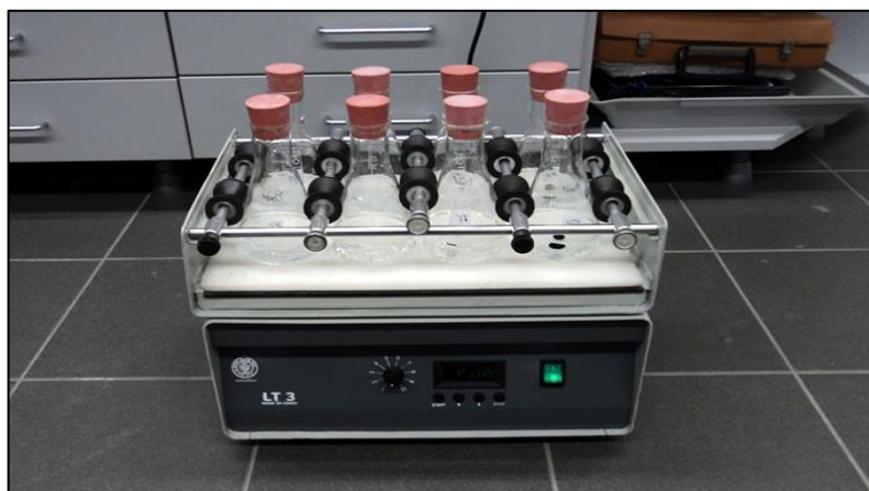
Obr. 19 - Třepačka LT 3 s vybranými skly v Erlenmeyerových baňkách
