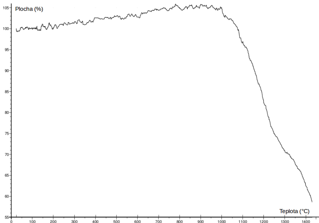
Graf 14 Žárově mikroskopická křivka pigmentu \text{Bi}_{1,5}\text{Pr}_{0,5}\text{Ce}_2\text{O}_7 připraveného srážením při teplotě 1050 °C
