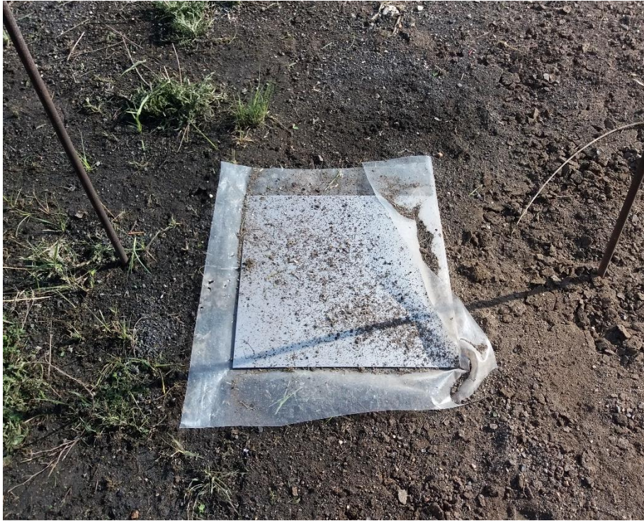
Obrázek 26 Kovový plech po odpalu nálože, kontaminace půdou
