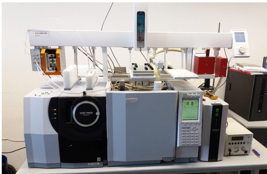
Obrázek 13 Plynový chromatograf GC-2010 (Shimadzu) spojený s hmotnostním spektrometrem GC-MSTQ 8030 (Shimadzu) a automatickým dávkovačem AOC-5000 (Shimadzu)
