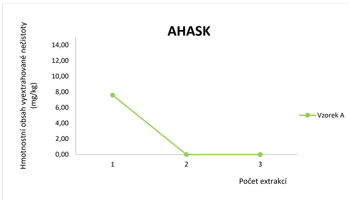
Obrázek 46: Vyextrahované množství AHASK pomocí vícenásobné extrakce v THF
