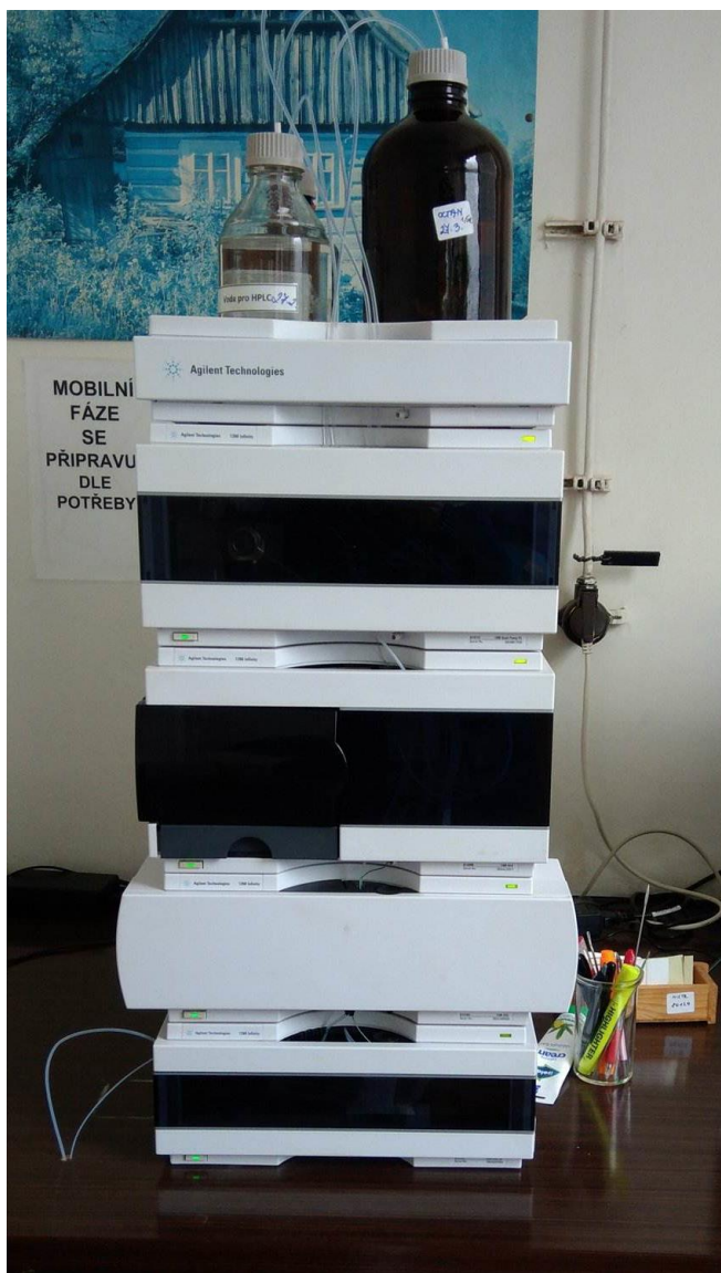
Obrázek 19: Kapalinový chromatograf Agilent 1260 Infinity
