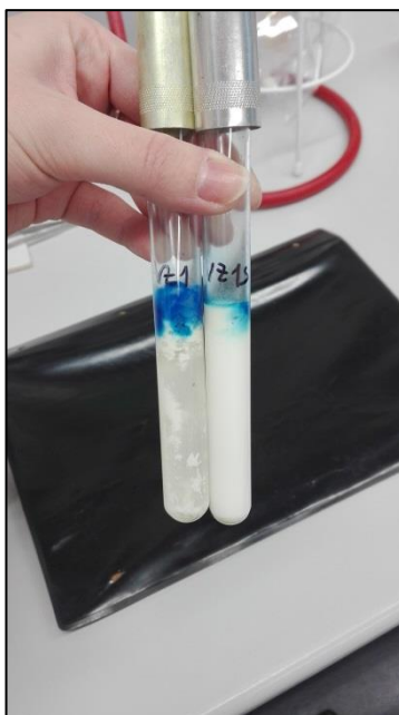
Obrázek 7: Reduktázová a kvasná zkouška pro skleněné lahve bez modifikace/s modifikací \text{Ag}^+ 20 \text{mg}/\text{m}^2
