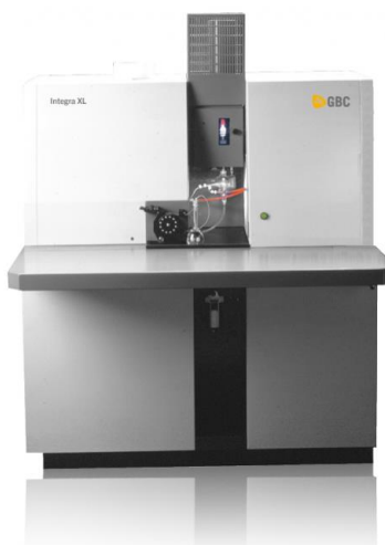
Obr. 15: Optický emisní spektrometr Integra XL[109]
