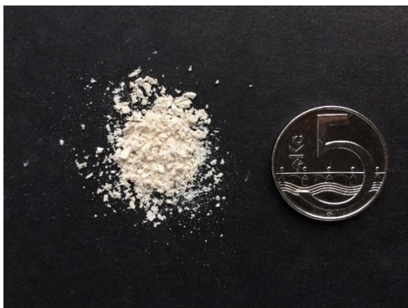
Obr. 6: Pomletý reálný vzorek - množství z kovové patronky ( 200 \leq 5 mg) v porovnání s kovovou mincí
