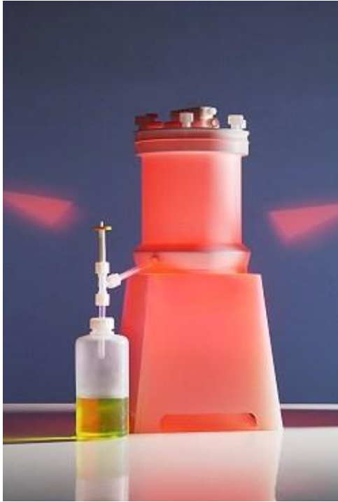
Obrázek 4 Destilační podvarové zařízení BSB 939IR
