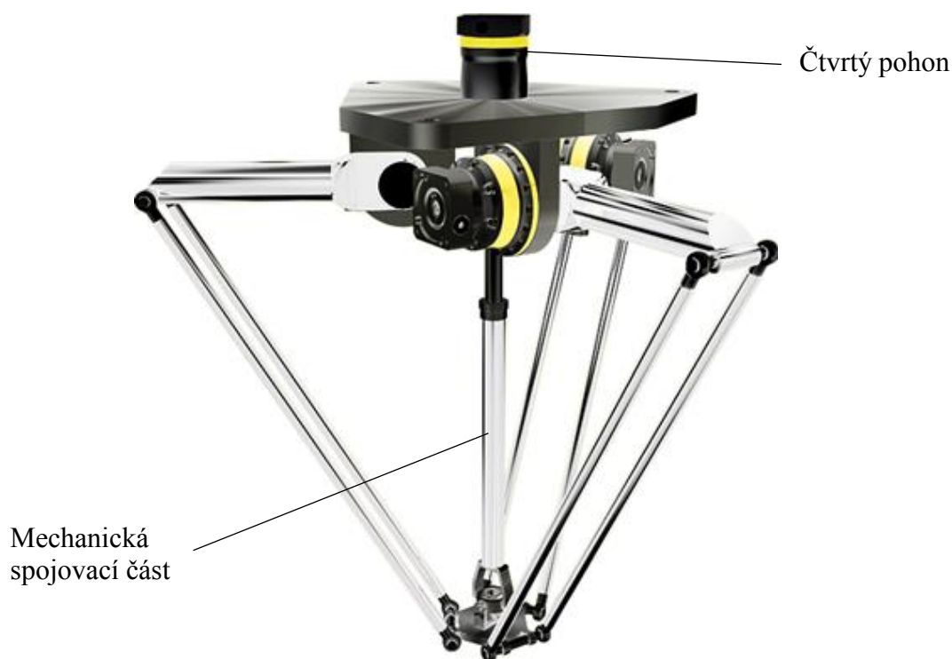
Obr. 3.6 – Konfigurace čtyřosého delta robota (Wittenstein, 2018)
