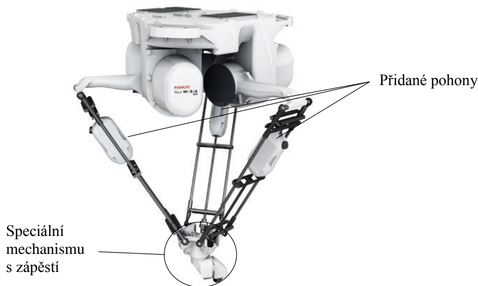
Obr. 3.7 – První typ realizace šestiosého delta robota (Fanuc, 2018e)
