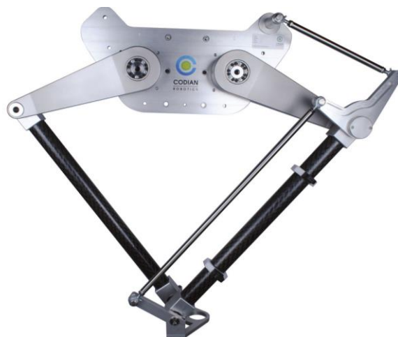
Obr. 3.3 – Dvouosý delta robot s rotačním pohonem (Codian robotics, 2018)
