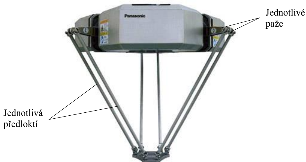
Obr. 3.8 – Druhý typ realizace šestiosého delta robota (Panasonic, 2018)
