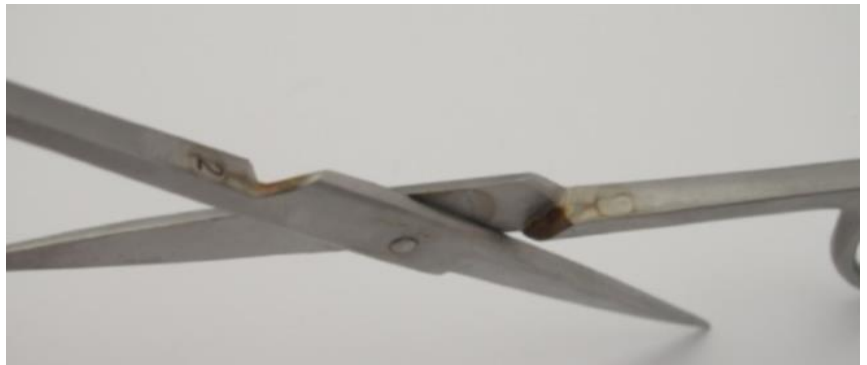
Obrázek 8 – koroze chirurgický nástrojů (zdroj: fotoarchiv MEDIN a.s.)
