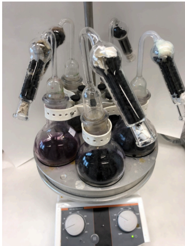
Příloha B Fotografie Starfish nástavce s 5-ti 250ml kulatými baňkami na elektromagnetickém míchadle
