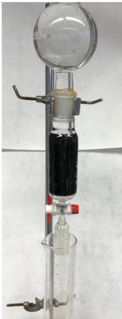
Příloha A Fotografie skleněné laboratorní kolony plněné GAC
