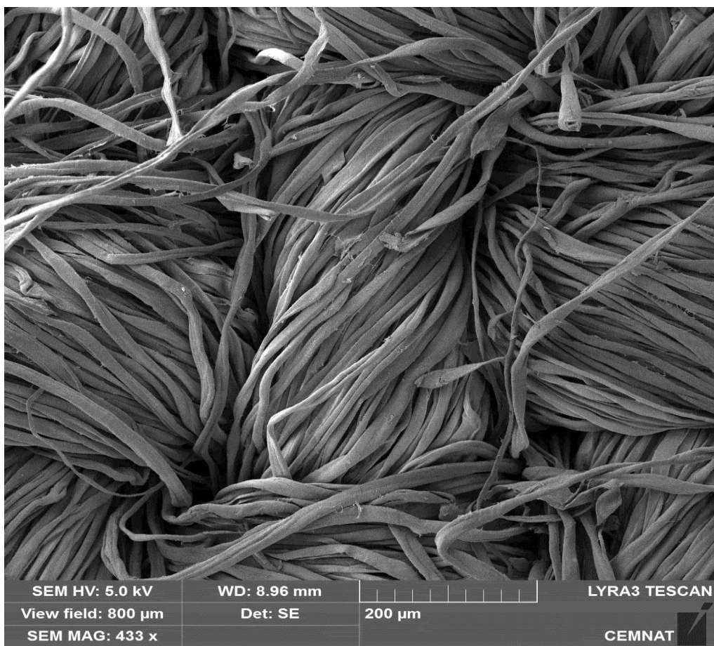
Obrázek 32: Snímek z SEM pro upravená bavlněná vlákna – kationizace Sokoflok
