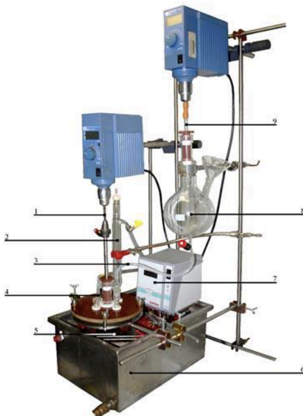
Obrázek 3 Aparatura pro emulzní polymeraci: 1 – míchadlo; 2 – zpětný chladič; 3 – přívod monomerů; 4 – přívod inertního plynu (N 2 ); 5 – polymerační reaktor; 6 – vodní lázeň; 7 – termostat; 8 – emulgační baňka; 9 – rychloběžné míchadlo
