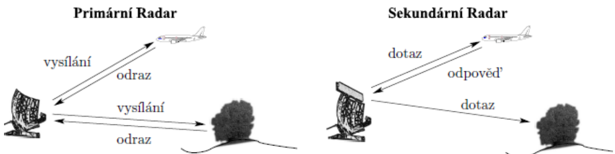
Obrázek 1 – Základní typy aktivních radarů [zdroj: (BEZOUŠEK, a další, 2004 str. 3)]
