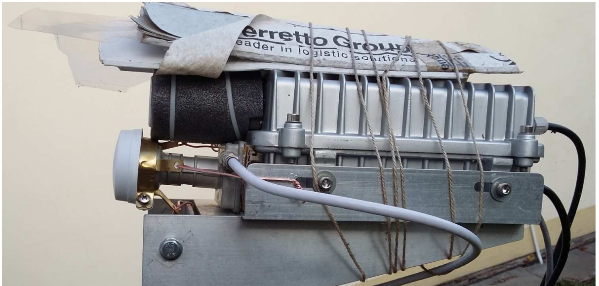
Obrázek 17: Umístění zářiče radiometru 11 GHz pod zářič Alphasatu 19 GHz
