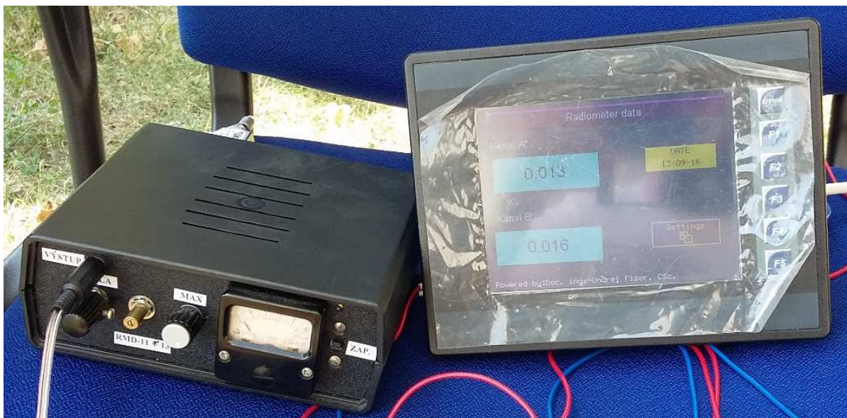
Obrázek 11: Radiometr 11 GHz s datalogerem
