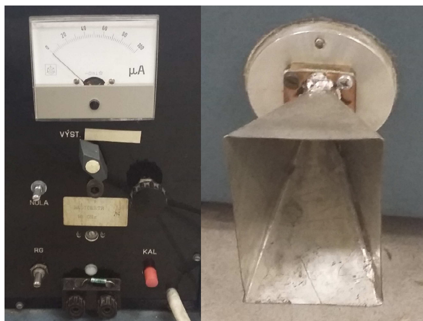
Obrázek 47: Ovládací panel a zářič radiometru 18 GHz
