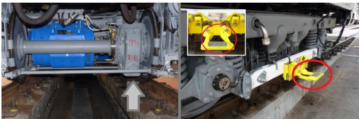
Obr. 8: Převodovka mezi koly vozu metra, sběrače proudu na vnější straně podvozku
