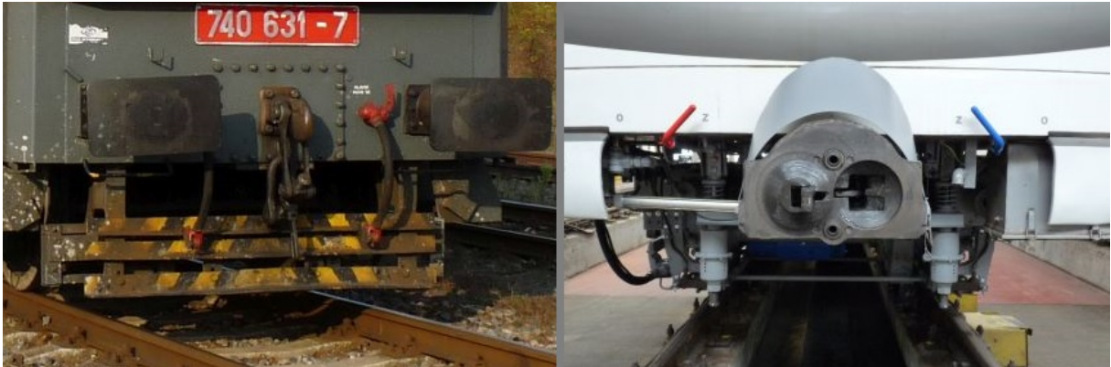
Obr. 9: Srovnání spřahovacích mechanismů
