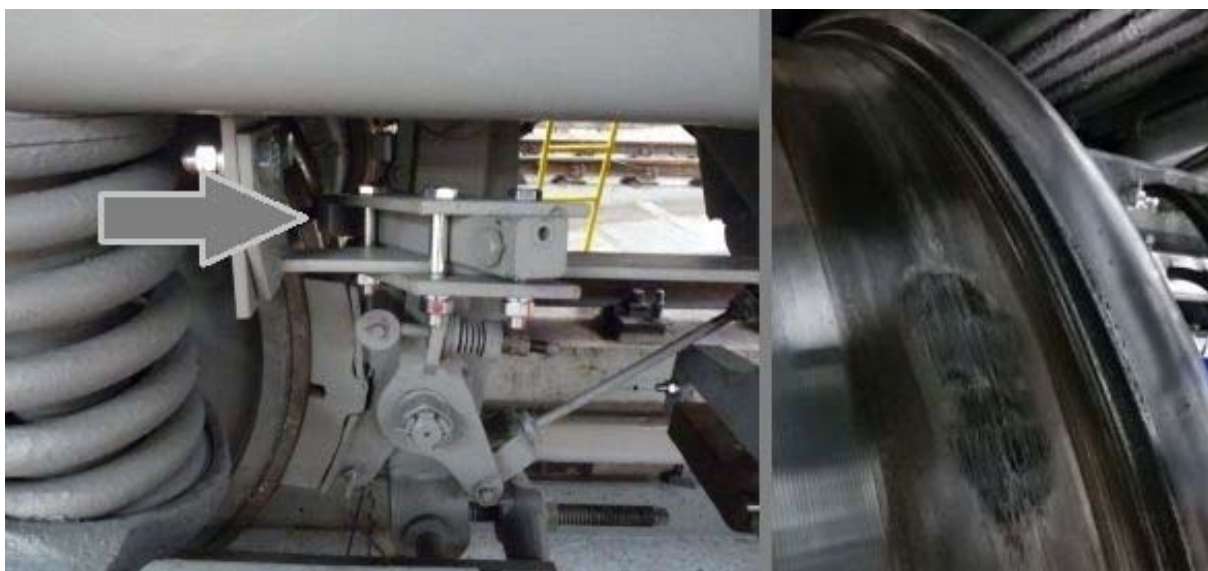
Obr. 4: Aplikátor tuhého maziva, poškozené kolo (plocha)
