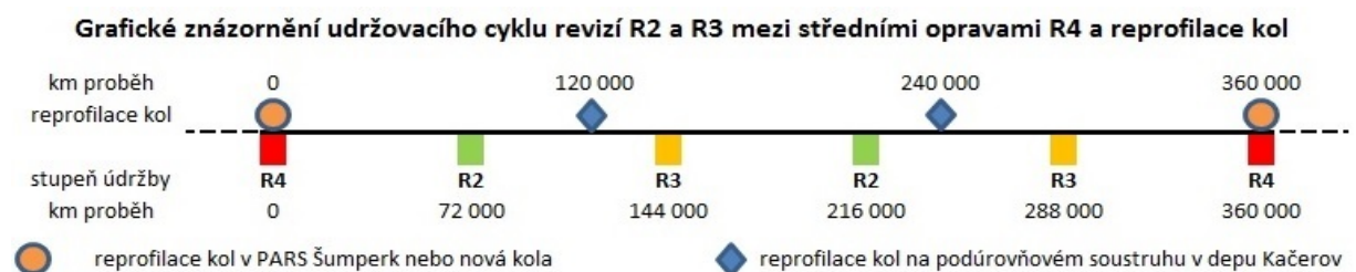
Obr. 6: Udržovací cyklus vyšších oprav a reprofilace dvojkolí souprav 81-71M
