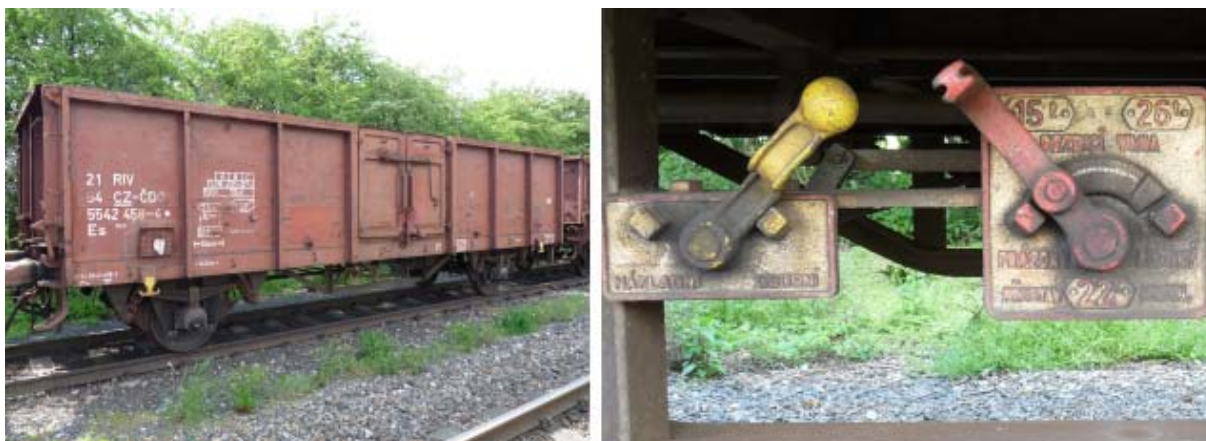
Obr. 17: Nákladní vůz Es, brzdové přestavovače vozu Es
