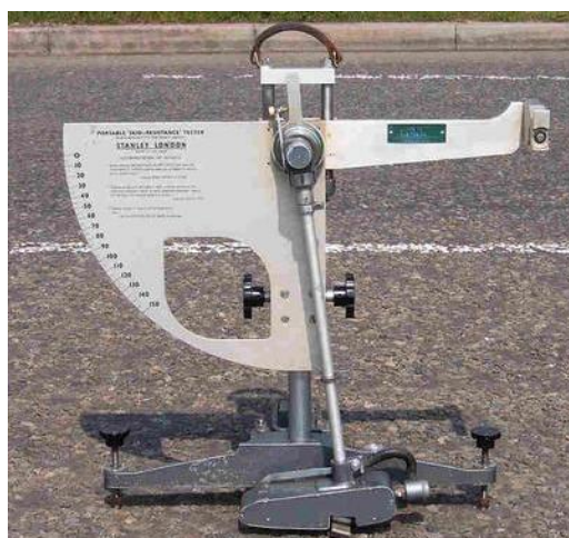
Obr. 29 – Zkušební zařízení – kyvadlo [27]
