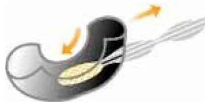
Obr. 10 – Změna přilnavosti diagonální pneumatiky při dočasném přetížení [21]
